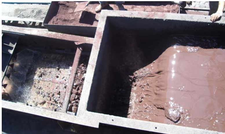
Şekil 2.1. Drewboy ayırıcısında pirit külü ile ağır ortam zenginleştirme
