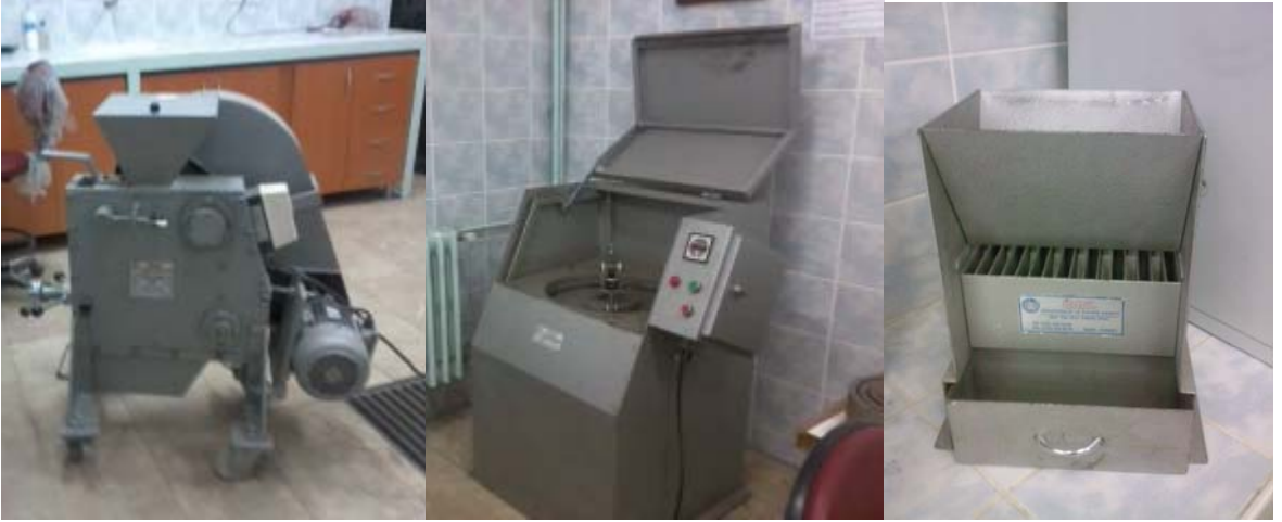
Şekil 2.3. Deneylerde kullanılan örnek hazırlama ünitesi a) Çeneli Kırıcı, b) Merdaneli Kırıcı c) Örnek Bölücü
