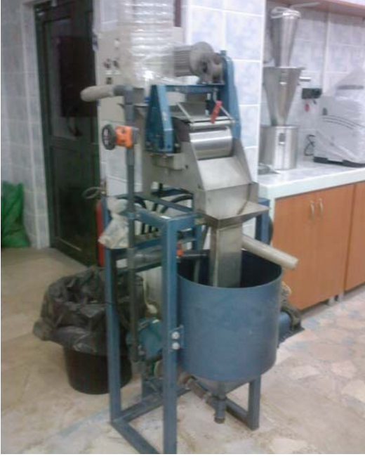
Şekil 2.7. Deneysel olarak kullanılan düşük alan şiddetli manyetik ayırıcı ve çalışma sistemi
