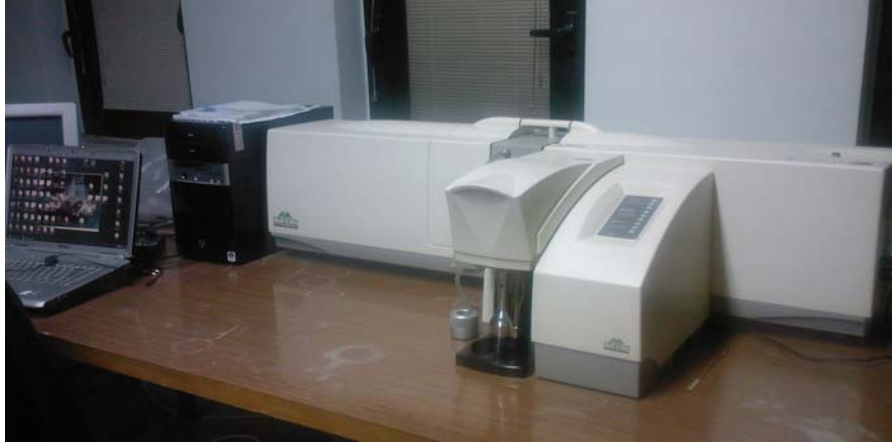
Şekil 2.6. Tane boyut analizlerinde kullanılan Mastersizer 2000 MU cihazının görünümü
