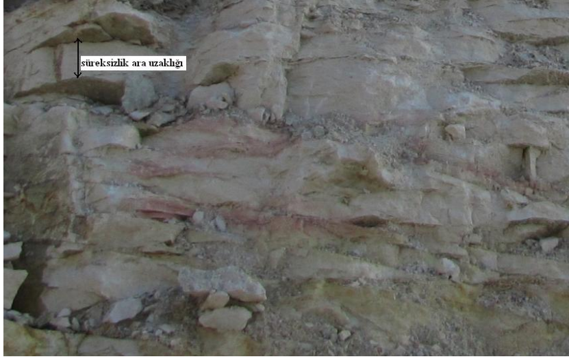
Şekil 29. Arazide süreksizlik ara uzaklığının görünümü
