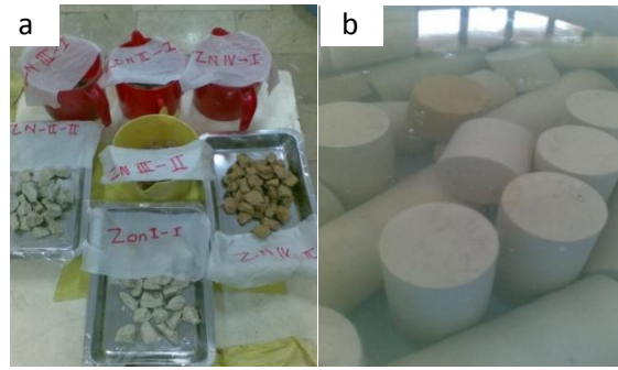
Şekil 25. Şekilsiz (a) ve belirli bir şekle sahip karot numuneleri (b)
