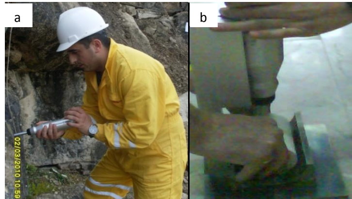
Şekil 20. Schmidt çekicinin arazide (a) ve laboratuarda uygulaması (b)
