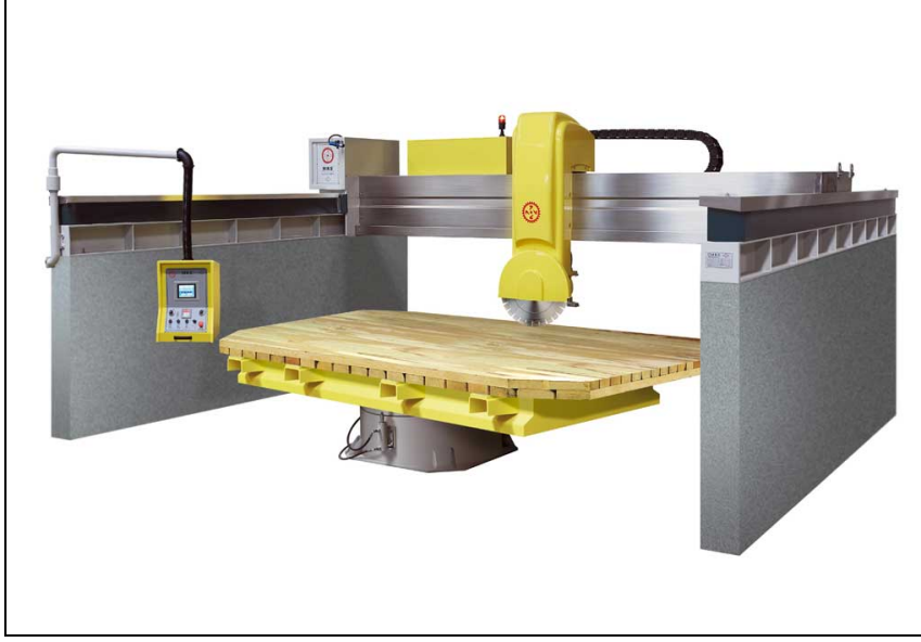
Şekil 1.3. Köprü kesme makinesi (URL–3, 2009).
