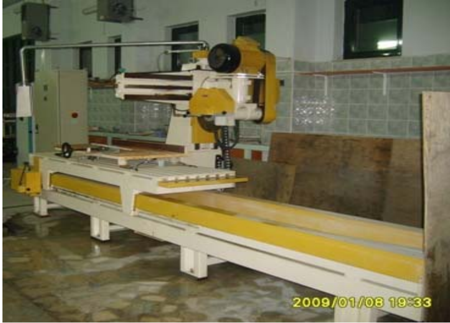
Şekil 3.1. Deneysel alıřmalarda kullanılan otomatik yan kesme makinesi(genel görünüm)
