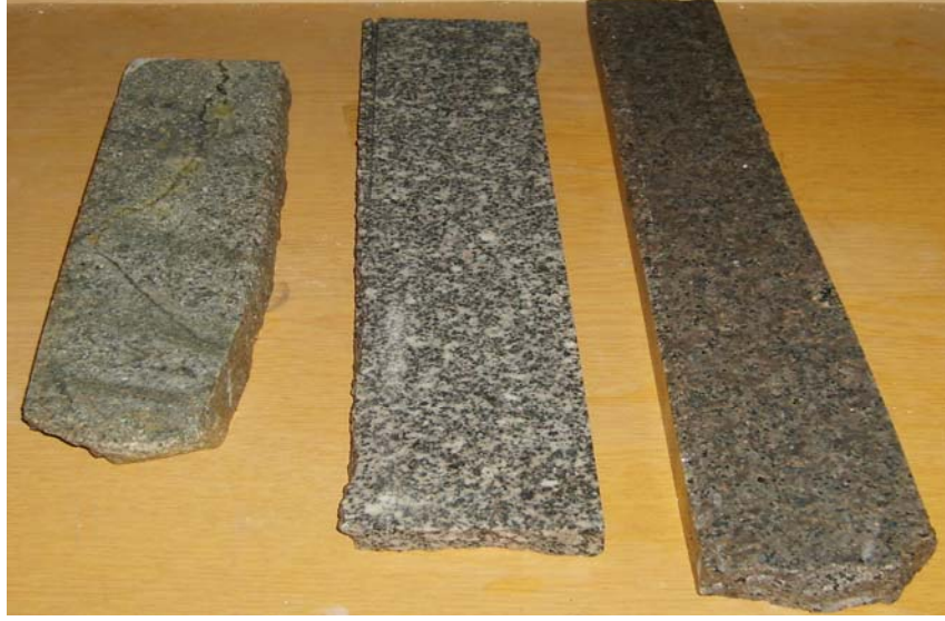
Şekil 3.4. Deneysel çalışmalarda kullanılan örnekler. Soldan itibaren Rize İkizdere graniti, Giresun Harşit graniti ve Giresun Vizon graniti
