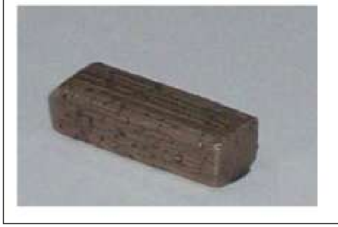
Şekil 3.6. Deneysel çalışmalarda kullanılan elmas soket
