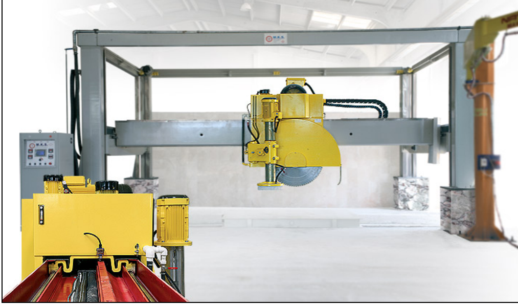
Şekil 1.1. Blok kesme makinesi (S/T) (URL-1, 2009).
