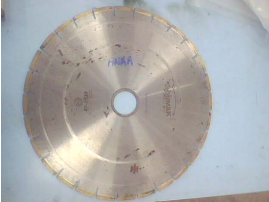
Şekil 3.5. Elmas soketli dairesel testere
