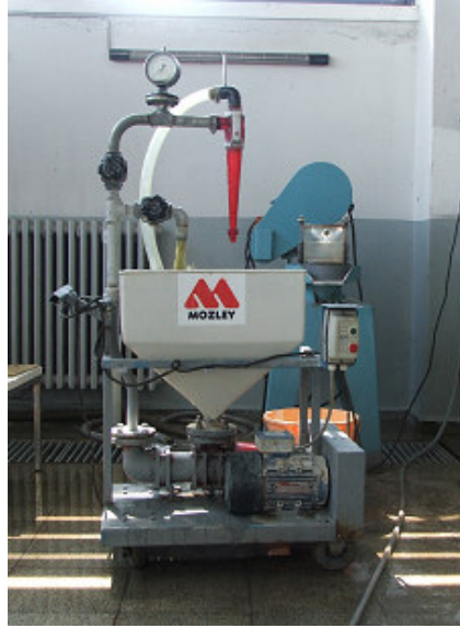
Şekil 2.3. Zenginleştirme işlemlerinde kullanılan laboratuvar ölçekli hidrosiklon
