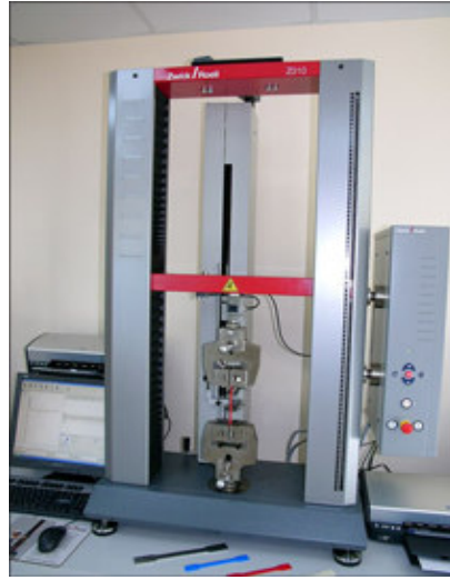
Şekil 2.8. Zwick marka Z-100 modeli çekme-basma test cihazı
