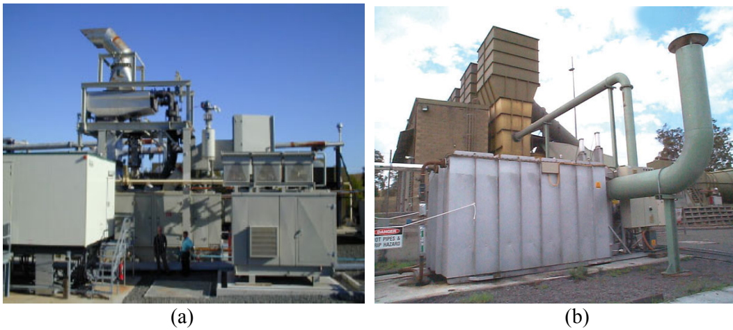
Şekil 2.10. a) İngiltere ve b) Amerika'daki kömür madenlerinden atmosfere yayılan metanın oksitlenmesi için kurulan bir sistem (Carothers vd., 2003).
