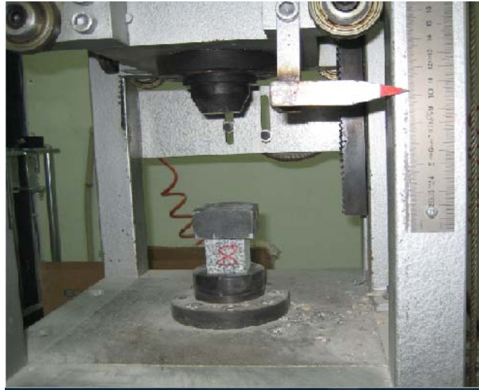
Şekil 2.17. Darbe dayanımı deneyinde numunenin yapılışı
