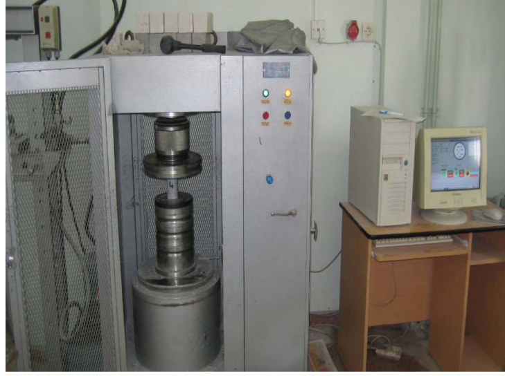
Şekil 2.5. Tek eksenli basma dayanımı deney düzeneği
