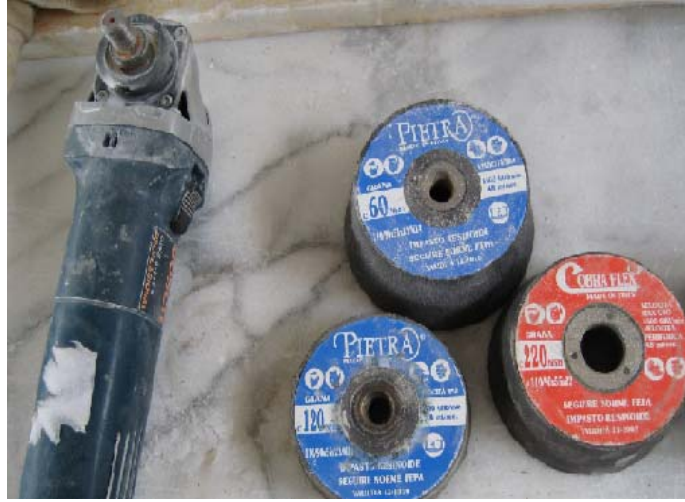
Şekil 2.31. Cilalama işlemi için kullanılan taşlama diskleri
