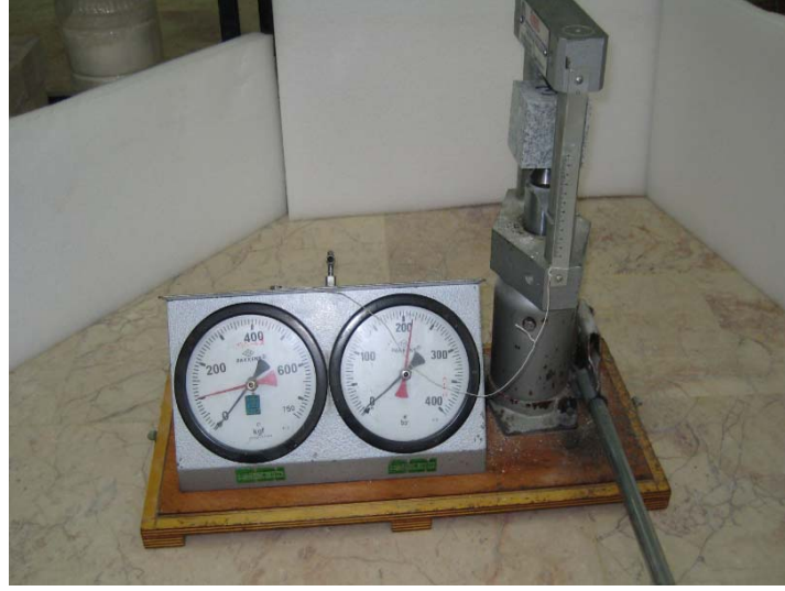
Şekil 2.7. Nokta yük deney düzeneği
