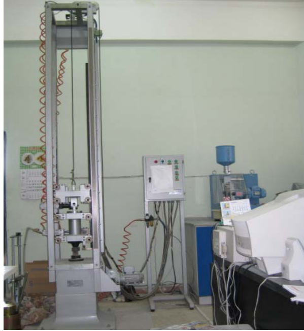
Şekil 2.16. Darbe dayanımı deney düzeneği
