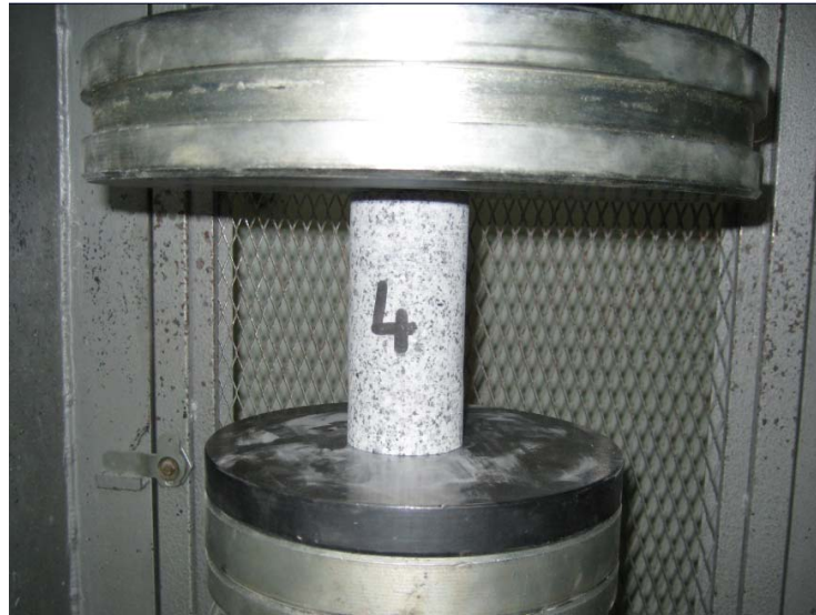
Şekil 2.6. Tek eksenli basınç deneyinin yapılışı
