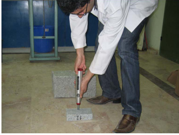
Şekil 2.26. Laboratuarda Schmidt Çekici ile sertlik belirlenmesi
