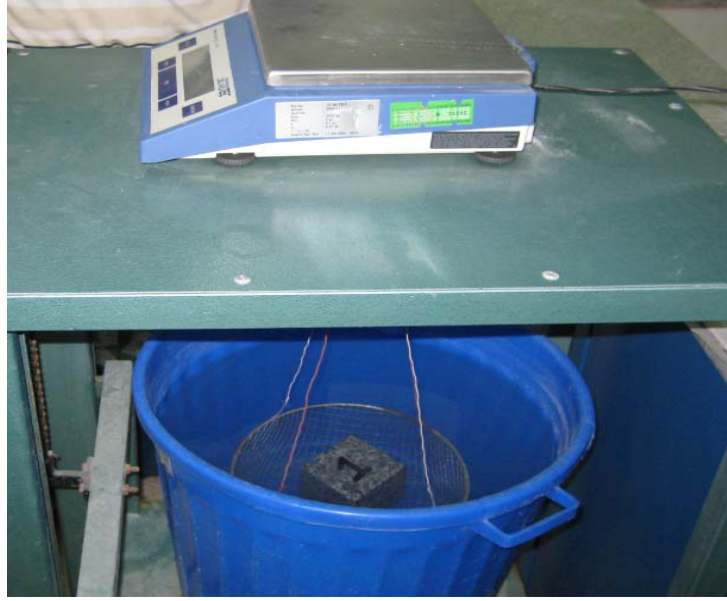
Şekil 2.4. Arşimet terazisiyle numune tartımı
