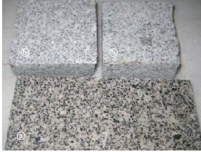
Şekil 2.32. a) Cilalanmış ve parlatılmış numune, b) her hangi bir işleme tabii tutulmayan numune
