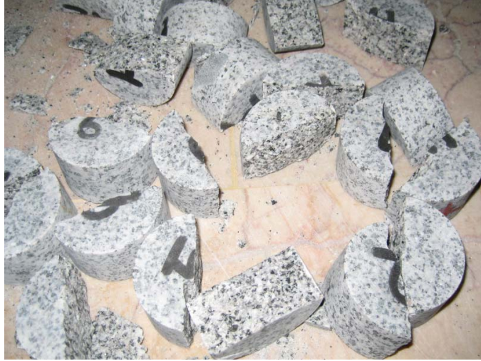
Şekil 2.11. Yarmada çekme dayanımı deneyinin örneklerin kırılma şekilleri
