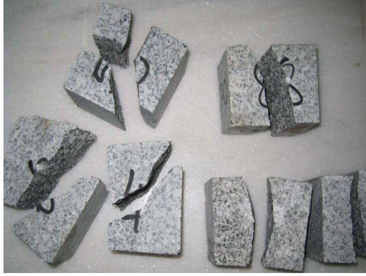
Şekil 2.8. Nokta yük dayanımı sonucu örneklerin kırılma şekilleri
