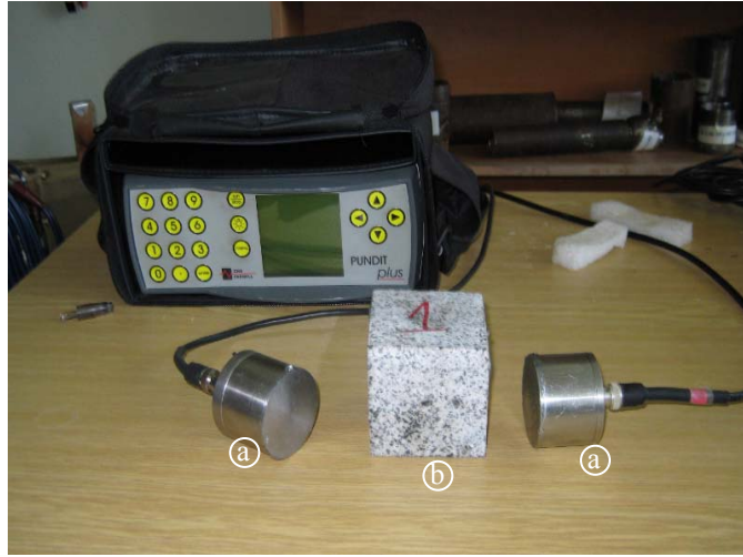
Şekil 2.25. Ultrasonik hız deneyinin yapılışı, a) prop, b) 7 x 7 x 7 cm numune
