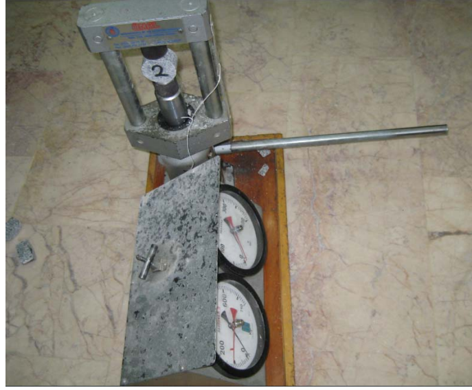
Şekil 2.10. Yarmada çekme deneyinin yapılışı
