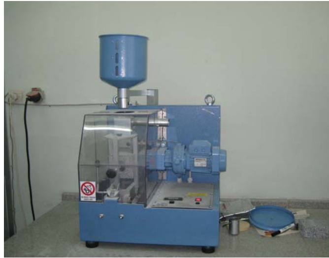
Şekil 2.20. Disk aşındırma deney düzeneği
