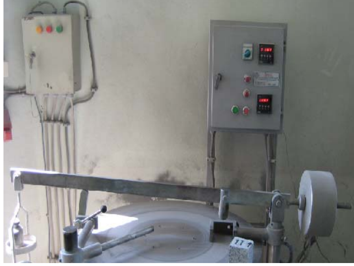
Şekil 2.18. Böhme yüzey aşındırma deney düzeneği
