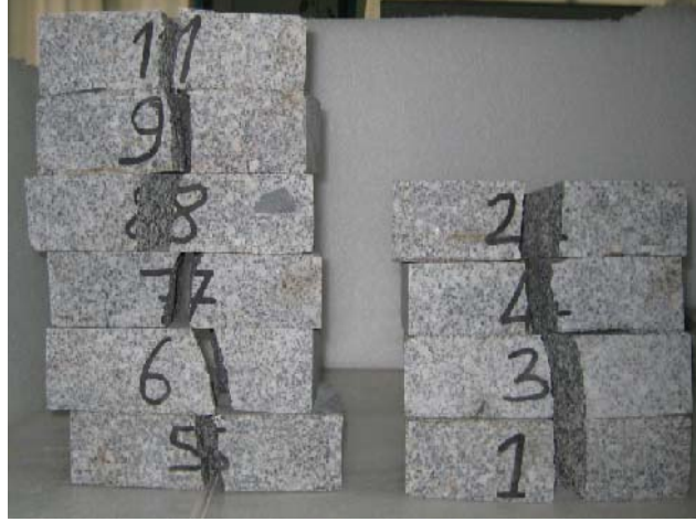
Şekil 2.14. Eğilme dayanımı numunelerinin kırılış şekilleri
