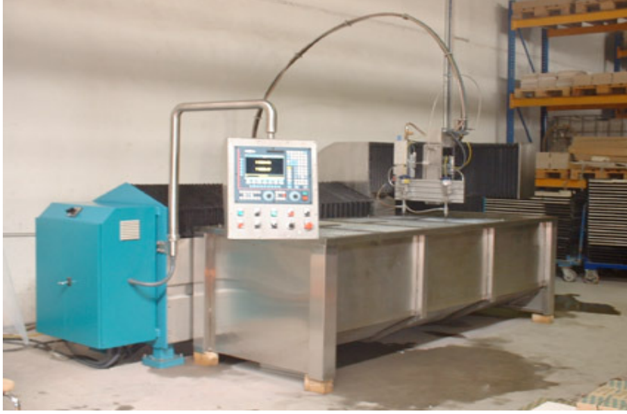
Şekil 2.2. Deneysel çalışmalarda kullanılan su jeti makinesi (genel görünüm) (CT Kesme Tek. ve Mak. San ve Tic. Ltd. Şti. izniyle, 2006).
