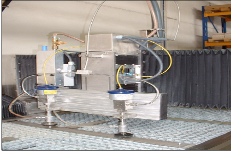
Şekil 2.3. Deneysel çalışmalarda kullanılan su jeti makinesi (Kesme kafaları) (CT Kesme Tek. ve Mak. San ve Tic. Ltd. Şti. izniyle, 2006).
