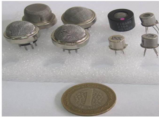
Şekil 2.8. a) TGS 8xx serisi b) TGS 2xxx serisi gaz sensörlerinin elektriksel eşdeğer devresi c) E-burunda kullanılan tüm sensörler
