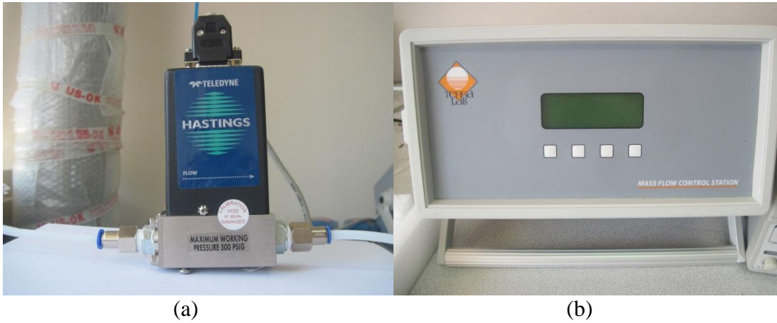
Şekil 2.5. Akış kontrol sistemi elemanları a) KAK b) Kütle akış kontrol istasyonu
