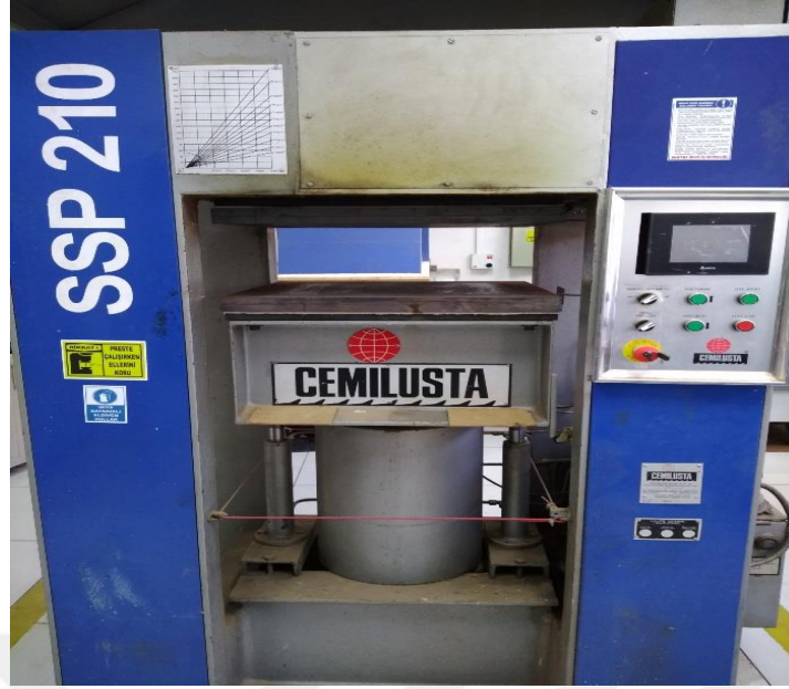
Şekil 15. Deneme levhalarının üretiminde kullanılan pres
