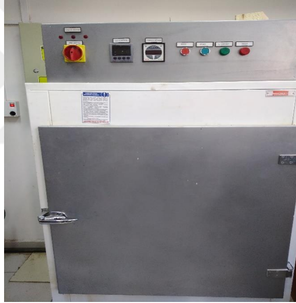
Şekil 14. Liflerin kurutulduğu kurutma fırını
