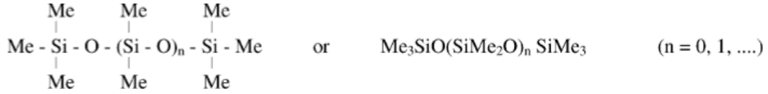
Şekil 4. Polidimetilsiloksan temel yapısı (Buyl, 2001)
