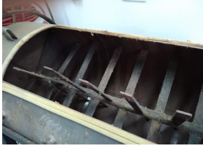
Şekil 13. Lif topaklarını açmak için kullanılan tutkallama makinası
