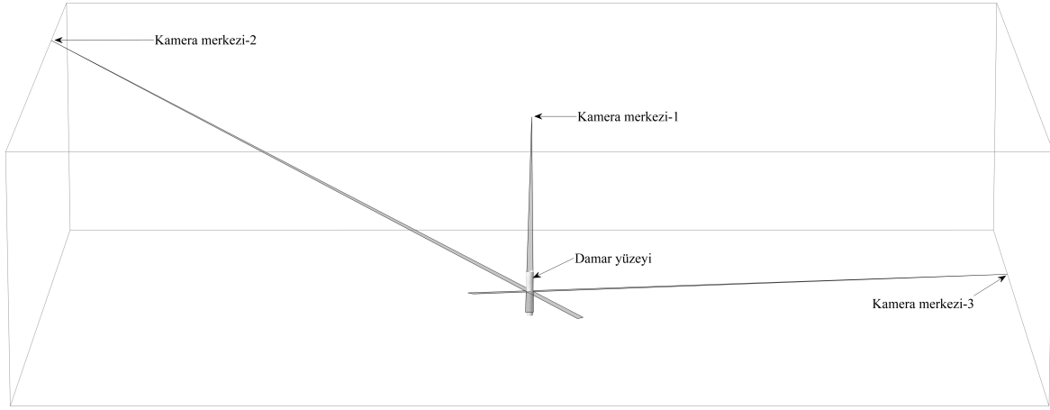
Şekil 89. Üç farklı açıdan gerçekleştirilen bir anjiyo simülasyonu.
