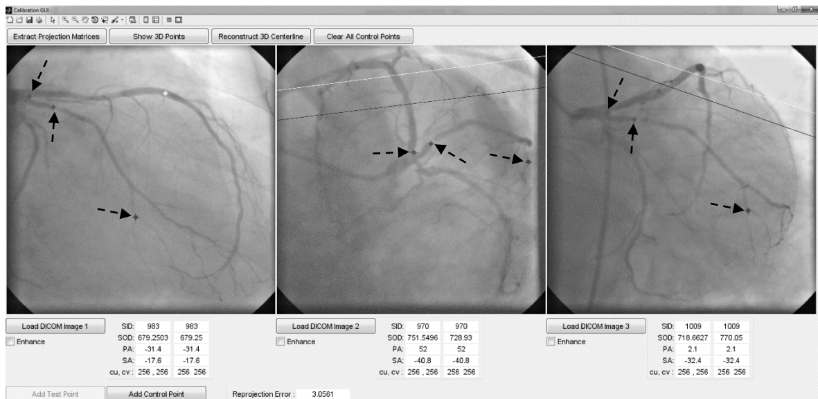
Şekil 36. Üç adet kontrol noktası eklenmiş gerçek anjiyo görüntüsü ve kalibrasyon sonucu.
