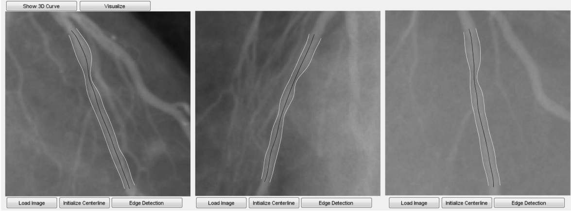
Şekil 103. Gerçek görüntüler üzerinde yapılan üç boyutlu modelleme çalışması-2. Merkez eksen ve kenar belirleme aşaması.
