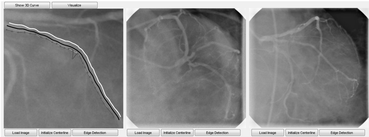
Şekil 83. Kenar belirleme işleminden sonra yapılan manuel düzeltme işlemi.
