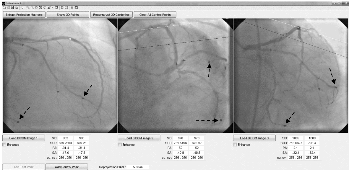
Şekil 37. 5 adet kontrol noktası eklenmiş kalibrasyon işlemi sonucu.
