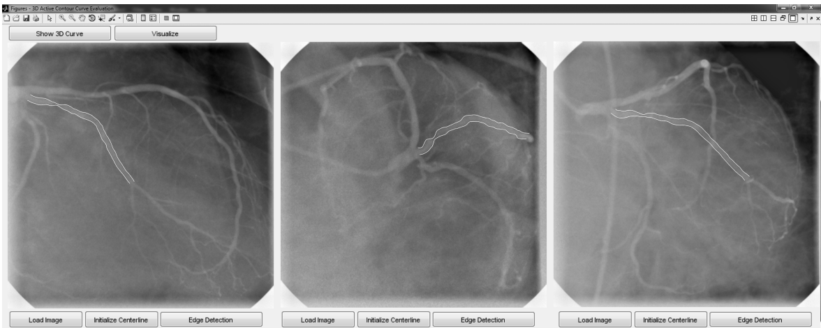
Şekil 84. Kenar kestirimi işleminin tüm görüntülere uygulanmış durumu.
