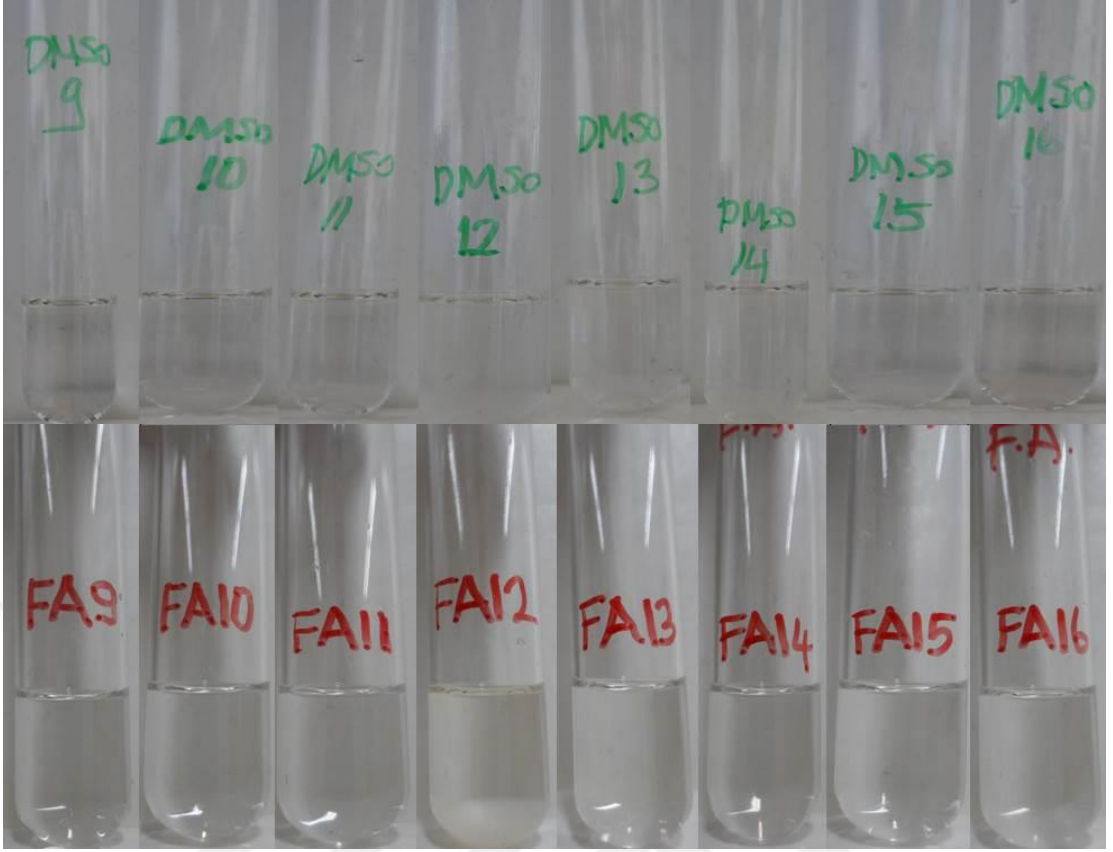
Ek Şekil 15. Etil asetat yöntemiyle sentezlenmiş selüloz asetat örneklerinin çözünme durumlarına ilişkin görüntüler (9: 1EA20S010; 10: 1EA20S025; 11: 1EA20S050; 12: 1EA20S100; 13: 1EA40S010; 14: 1EA40S025; 15: 1EA40S050 ve 16: 1EA40S100).
