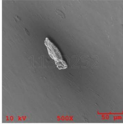
Şekil 109. 1ZN100100 kodlu örneğin kalıp yüzeyinin ve yüzey üzerindeki bir safsızlığın görüntüsü
