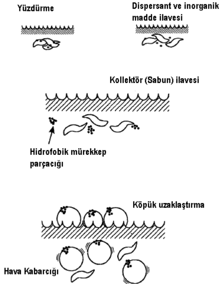
Şekil 8. Dört aşamada yüzdürme işleminin mekanizması(Ferguson, 1992 b )
