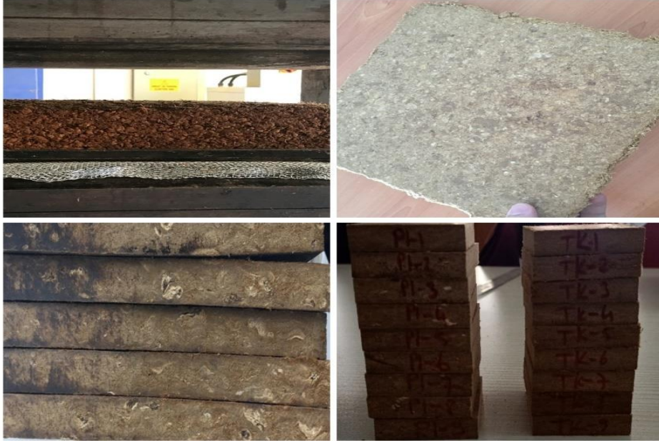
Şekil 9. Levha taslağı, miselyum esaslı levha ve test örneklerinin hazırlanması
