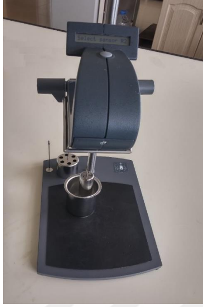
Şekil 9. Tutkal viskozitesi ölçümlerinde kullanılan viskozimetre ve ölçüm Aparatları
