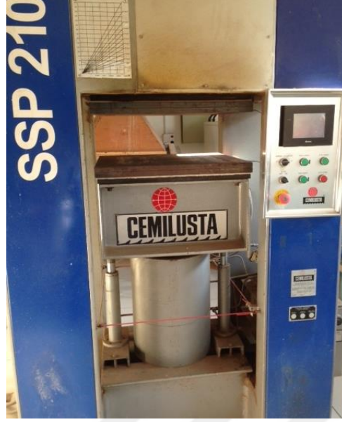
Şekil 7. Levha üretiminde kullanılan tek katlı pres
