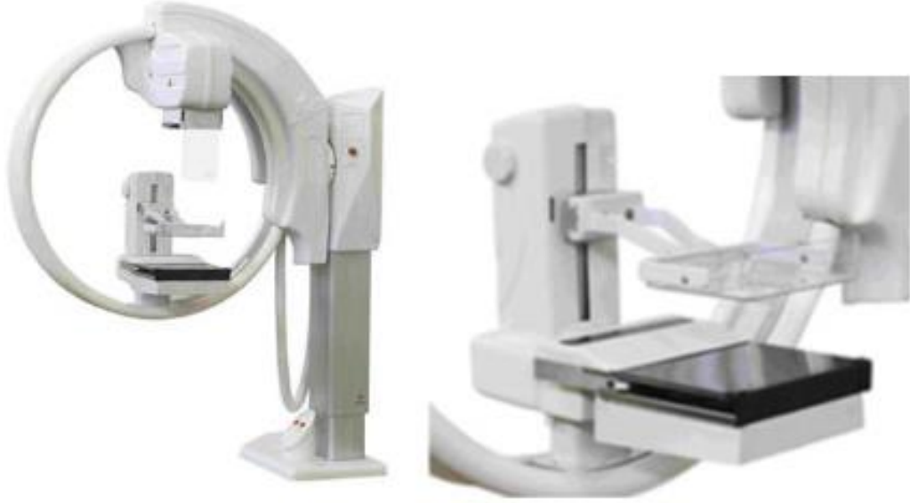
Şekil 2. Dijital mamografi cihazı ve kompresyon sistemi
