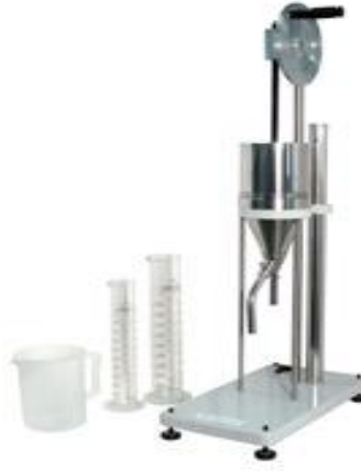
Şekil 18. Serbestlik Test Aygıtı (Schopper Aleti)
