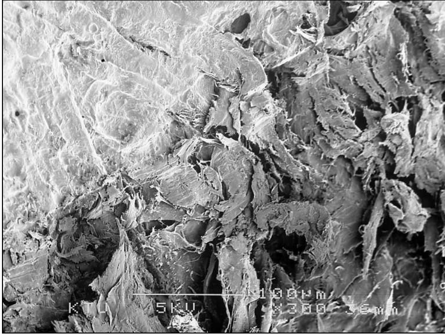
Şekil 24. SVK ile muamele edilmiş ağartılmış kraft hamurundan üretilen test kâğıdının üstten SEM görüntüsü
