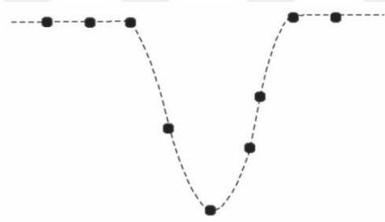
Şekil 173. Dakikaya karşı absorbanst grafiği çizilerek bu grafikten her bir fraksiyonun absorbanstının bulunmasının gösterimi (Şekil 173)
