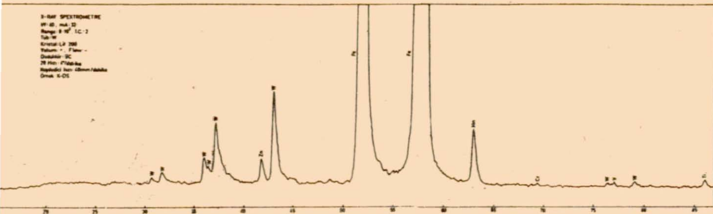
Şekil 24. Magnetik konsantrenin H_2SO_4 te çözünmesiyle elde edilen çözültiden . kristallendirilen FeSO_4 \cdot 7H_2O nun spektral element analizi
