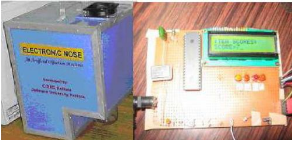
Şekil 1.13. Santi Sarkar Chowdhury ve arkadaşlarının yaptığı taşınabilir e-burun
