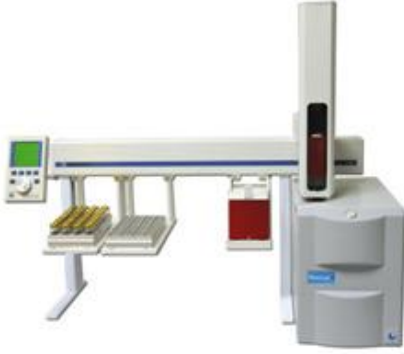
Şekil 1.10. Alpha MOS Heracles E-Burunun Fotoğrafı
