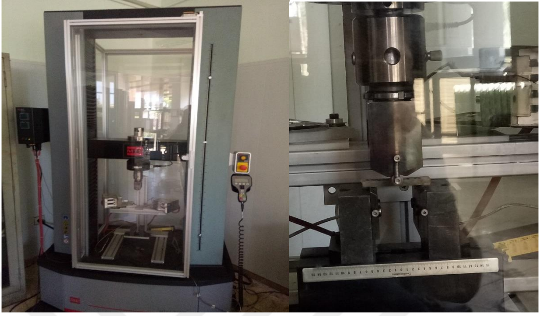
Şekil 52. Kompozit çimento örneklerinde eğilme, direnç ve dayanıklılık testi uygulanan test cihazı
