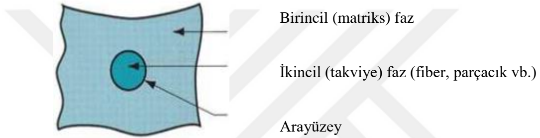
Şekil 13. Şematik olarak kompozit malzemenin bileşenleri [25].
