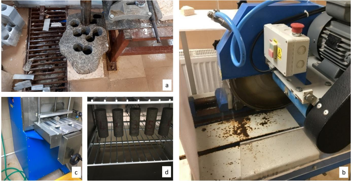
Şekil 13. Bloktan numune alınması (a), örneklerin kesilmesi (b), örneklerin uçlarının düzeltilmesi (c) ve örneklerin etüve atılması (d)
