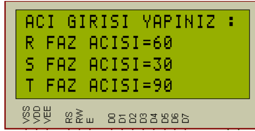
Şekil 5.8. Güç devresi için buton ile girilen IGBT elektronik anahtarına gönderilecek anahtarlama açılarının girişinin LCD ekrandaki görüntüsü
