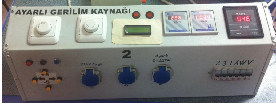
Şekil 5.2. Tasarlanan ferrerezonans sistemine ayarlı gerilim sağlayan ayarlı alternatif gerilim kaynağı
