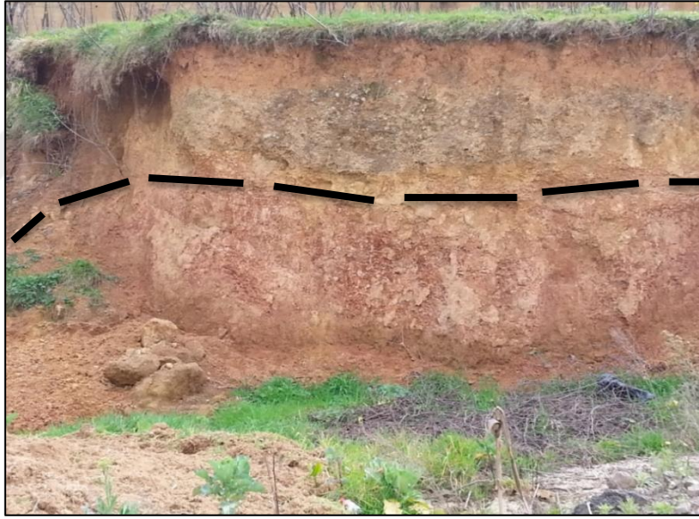
Şekil 23. İnceleme alanında gözlenen kırmızı killer üzerinde yer yer kalınlığı değişen organik bileşen içeren toprak örtüsü
