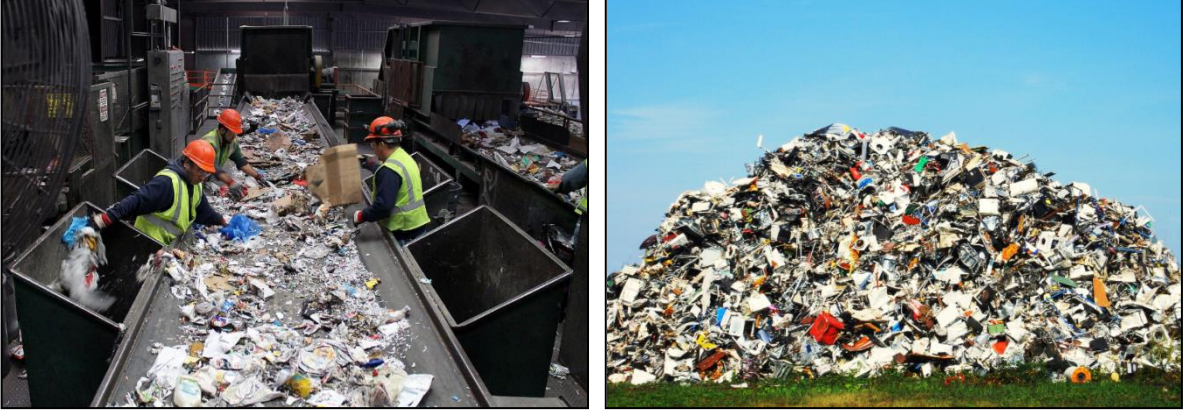
Şekil 2. Farklı tip atıkların ayrılması/sınıflandırılması (sol fotoğraf: nihai depolama alanında sınıflama, sağ fotoğraf: metallerin kaynağında sınıflandırılması)
