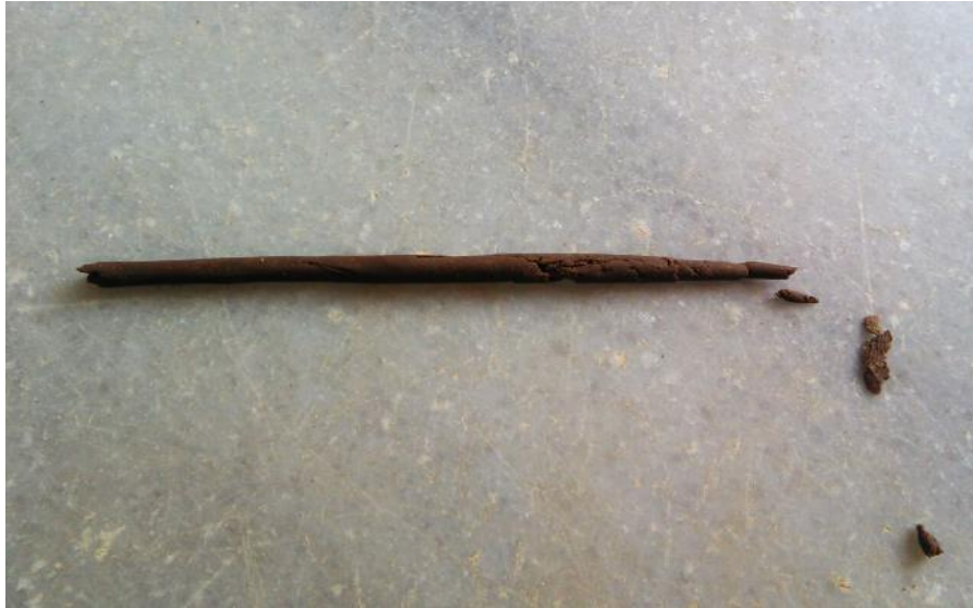
Şekil 13. Zeminin 3 mm çapında çubuklar haline getirilmesi
