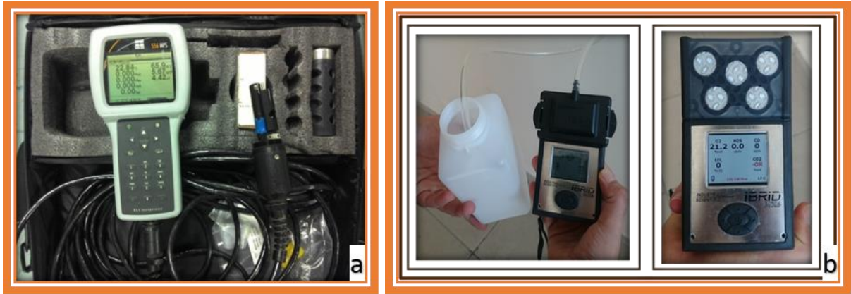
Şekil 4. YSI çoklu parametre ölçer (a), gaz ölçüm aleti ve gaz ölçümü (b).
