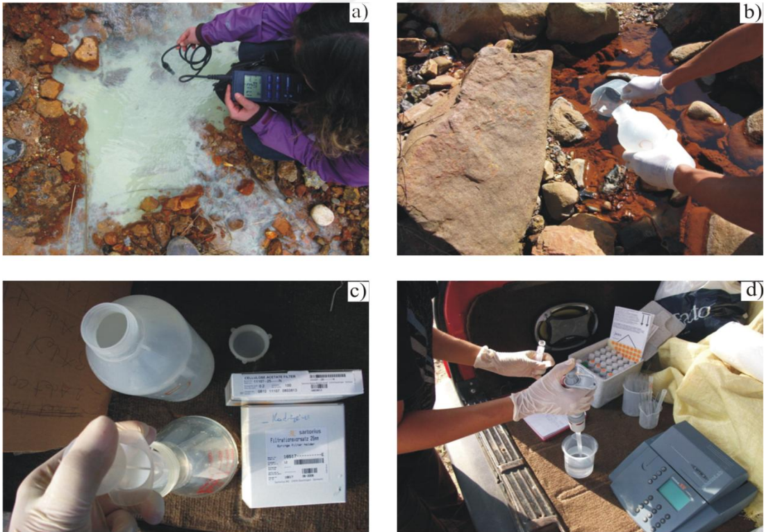
Şekil 3.4. a) pH, Eh, sıcaklık, iletkenlik ve tuzluluk ölçümleri b) su örneği alımı c) suyun şırınga yardımıyla filtrelenmesi d) fotometre ve küvetleri ile iyon ölçümü
