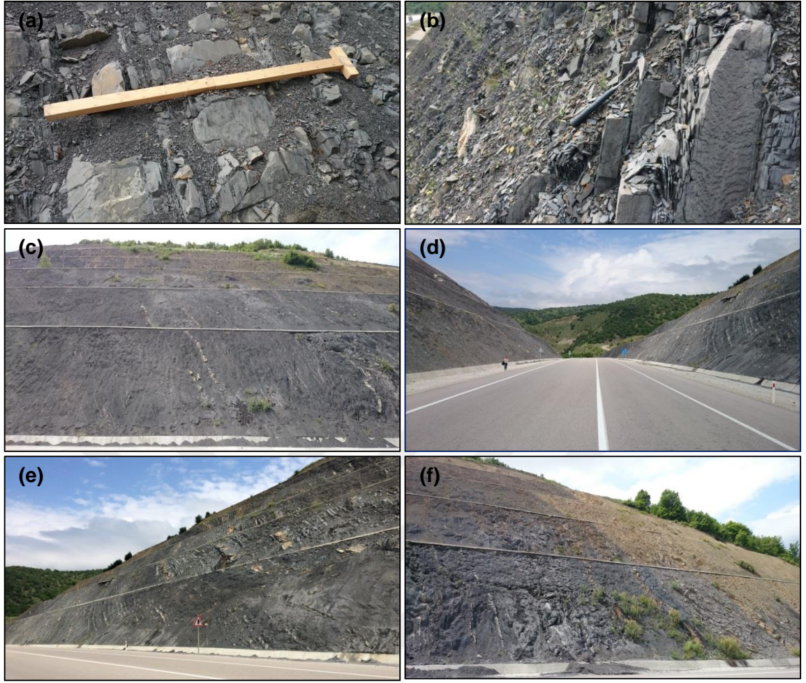
Şekil 11. Dranaz yöresinde yüzeyleme veren Çağlayan Formasyonuna ait kumtaşı ara katlı siyah şeyllerin arazideki görünümü. (a) Orta-kalın katmanlı siyah şeyller; (b) Belirgin yapraklanmalı yapıya sahip, istifin üst seviyelerinde yüzeyleyen siyah şeyller; (c) Kumtaşı ara katmanları içeren siyah şeyllerin arazideki görünümü; (d) Çağlayan Formasyonunun Dranaz yol yarmasındaki görünümü; (e) Dranaz ölçülü stratigrafik kesitinin alt ve orta seviyelerinin arazideki görünümü; (f) Dranaz ölçülü stratigrafik kesitinin üst seviyelerinin arazideki görünümü
