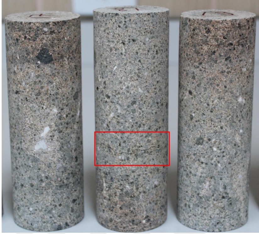
Şekil 3.11. 400°C sıcaklığa maruz kalmış havada soğumuş örneklerde meydana gelen termal kırık
