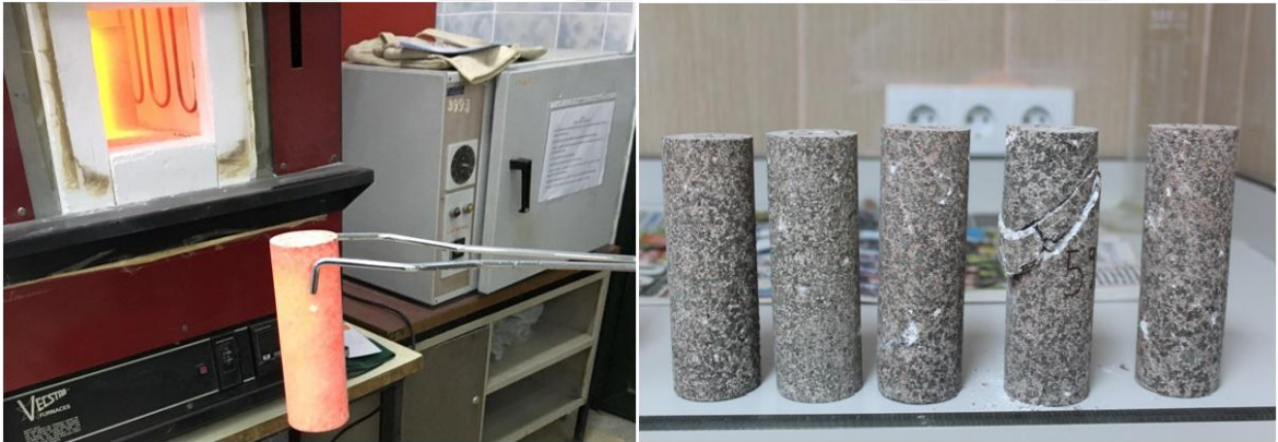
Şekil 3.14. 1000°C akkor halindeki ve havada soğumuş örnekler
