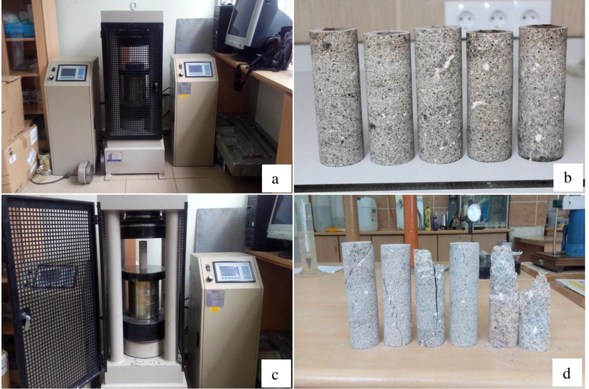
Şekil 2.5. Tek eksenli basınç deneyi aleti (a), deneye tabi tutulan örnekler (b), örneklerin tek eksenli basınç deneyi aletine yerleştirilmesi (c), deney sonrası kırılan örnekler (d)
