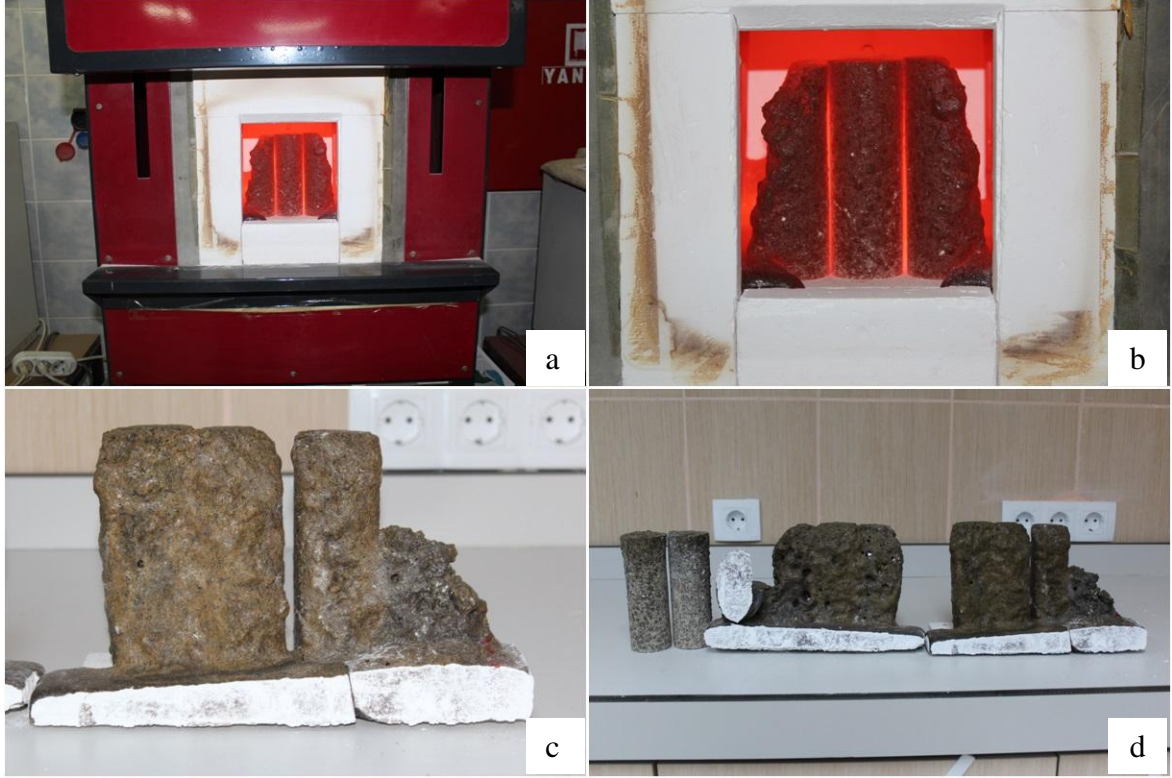
řekil 3.15. 1200°C sıcaklıkta erimiř rnekler
