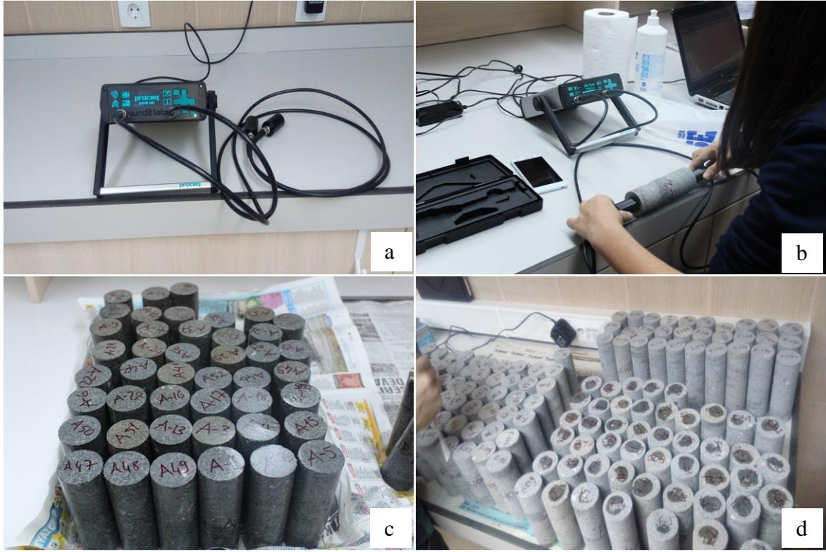
Şekil 2.6. Ultrasonik hız deney aleti (a), doğal örneklerin P dalga hızlarının ölçülmesi (b), doymuş örneklerin P dalga hızlarının ölçülmesi (c), kuru örneklerin P dalga hızlarının ölçülmesi (d)
