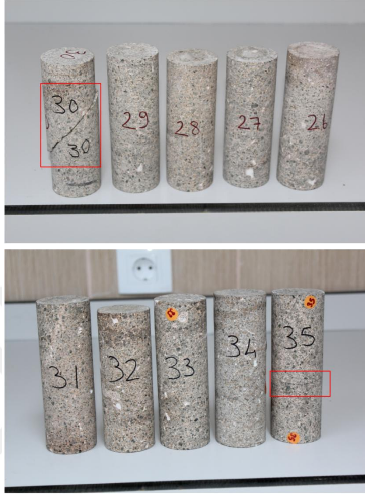
Şekil 3.12. 600°C sıcaklığa maruz kalmış havada soğumuş örneklerde meydana gelen termal kırık
