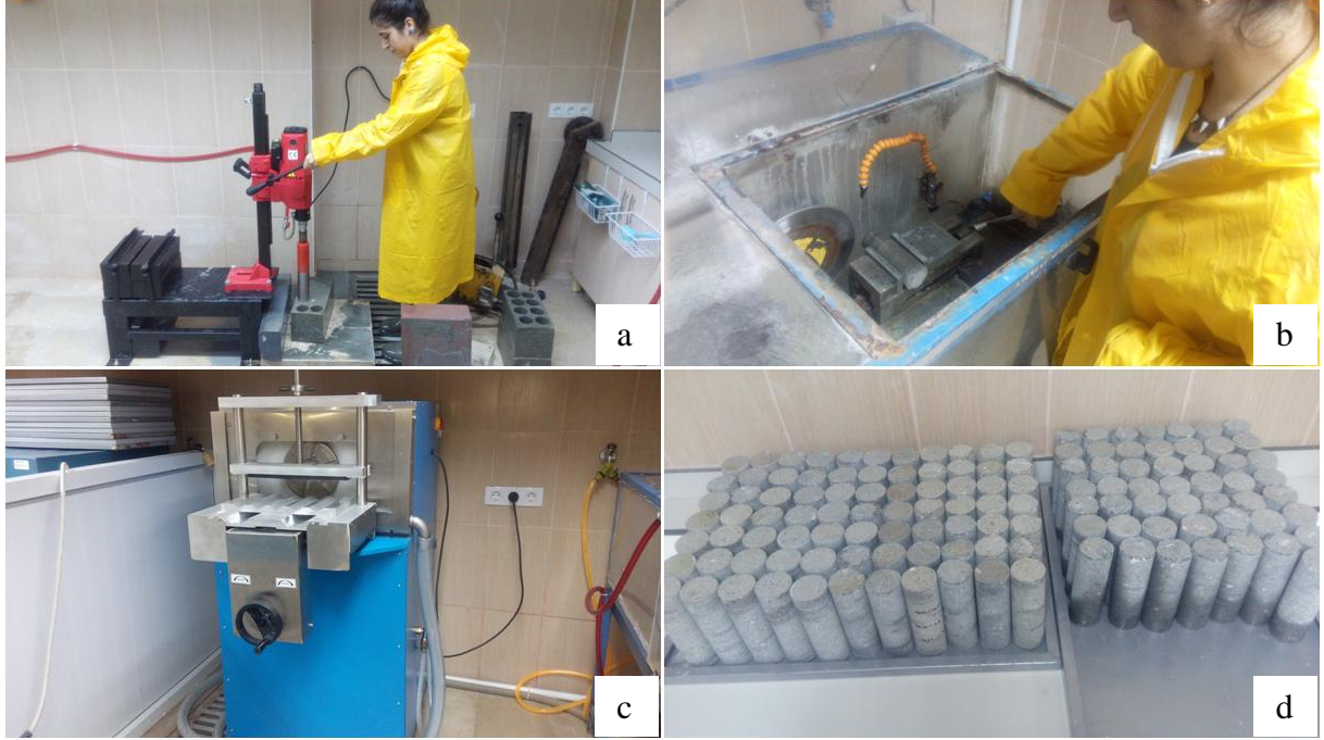
Şekil 2.2. Blok örneklerden silindirik örnek alma işlemi (a) (karot uçlarının kesilmesi (b), karot uçlarının düzeltilmesinde kullanılan karot ucu düzeltme makinası (c), deneyler için hazırlanmış silindirik numuneler (d))
