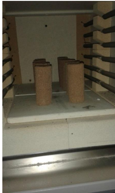
Şekil 19. 400 °C sonrasında karotların görünümü
