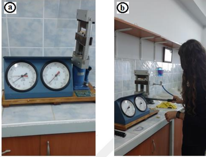
Şekil 9. (a) Disk makaslama deneyi aleti ve (b) yükleme işlemi
