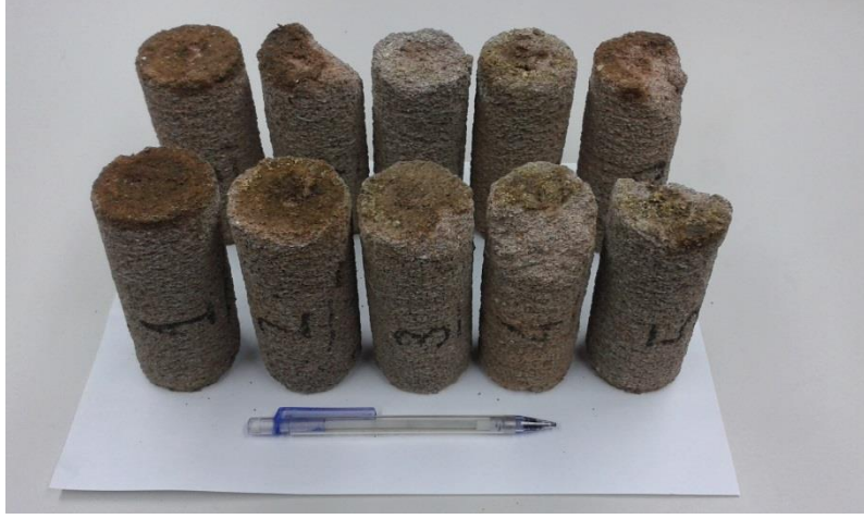
Şekil 23. Tüm sıcaklıklar sonunda yapılan deneyler sonrasında karotların görünümü
