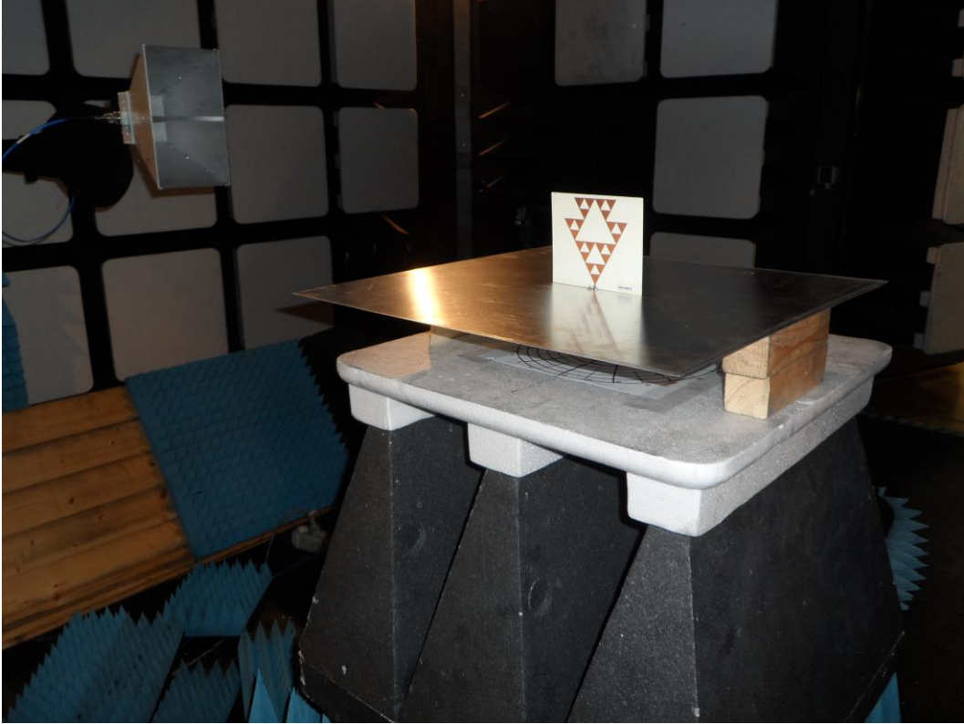
Şekil 2.72. 4iter260C2 anteni ve ölçüm düzeneği
