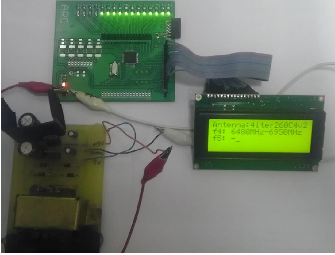
Şekil 2.74. 4iter260C4v2 anteninın tasarlanan ARC ile istenilen frekanslar için anahtarlaması
