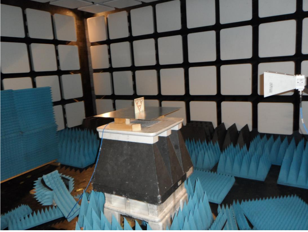
Şekil 2.71. 4iter260C2v2 anteni ve ölçüm düzeneği
