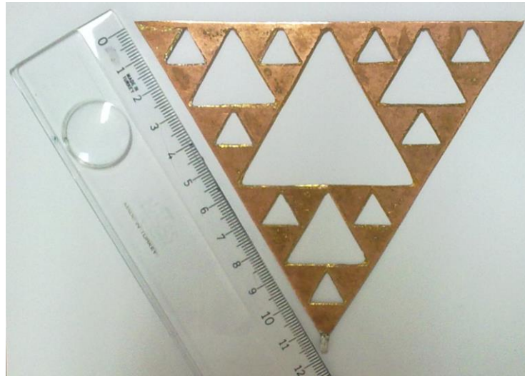
Şekil 2.42. Yalıtıksız 4iter260C1 anteni
