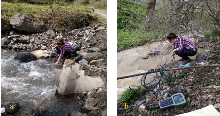
Şekil 4. a) Örneklemeye yapılan yüzey suyu b) YSI marka cihazla yapılan yerinde ölçüm
