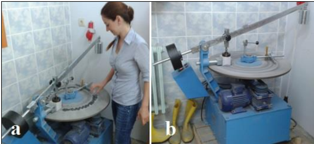
Şekil 2.6. a) Döner yüzey üzerine aşındırıcı toz dökülmesi, b) Dönmekte olan diske temas halindeki numunenin aşındırılması
