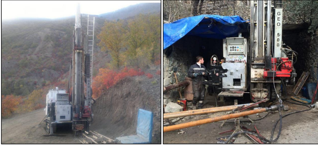
Şekil 2.1. GEO-500 ve GEO-1500 sondaj makinesi
