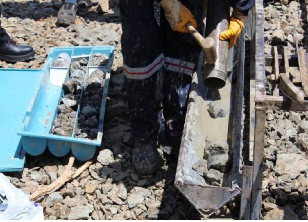
Şekil 2.4. Tek tüplü karotiyerden örnek alınması
