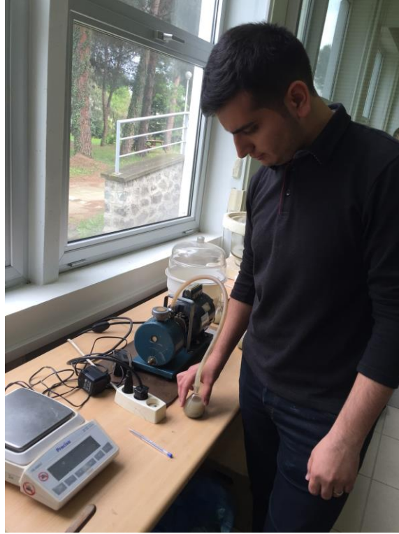
Şekil 2.6. Piknometre deneyinin yapılışı
