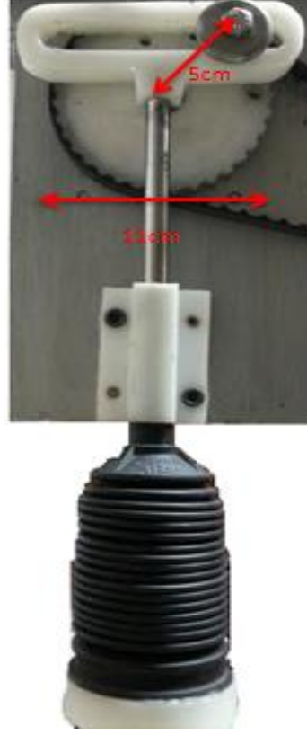
Şekil 2.17. Kompresyon için Scotch-Yoke mekanizması
