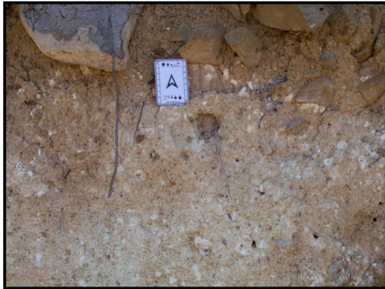
Şekil 3.17. Alüvyonlar içerisinde bulunan beyaz renkli karbonat nodülleri.
