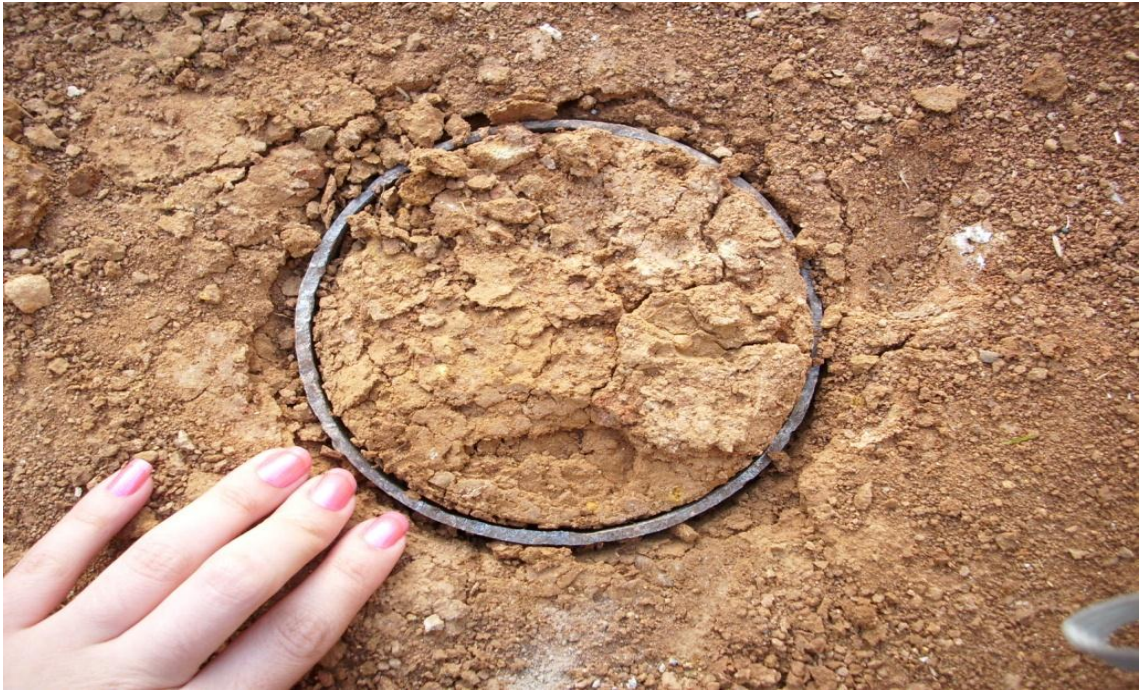
Şekil 2.5. Zeminden örnek alımı
