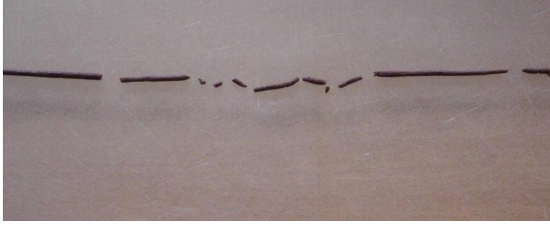
Şekil 2.9. Plastik limit deneyinde elde edilen 3mm çapındaki silindirik parçalar
