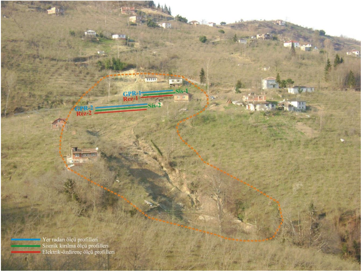
Şekil 3.6. Çalışma alanında jeofizik yöntemlerin uygulandığı profillerin görünümü (mavi renk hat yer radarı ölçü profilini, yeşil renk hat sismik kırılma ölçü profilini ve kırmızı renk hat elektrik özdirenç ölçü profilini göstermektedir)
