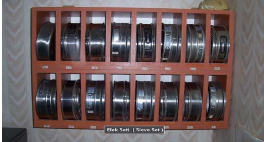
Şekil 2.6. Elek Seti (ASTM 1993'e göre)
