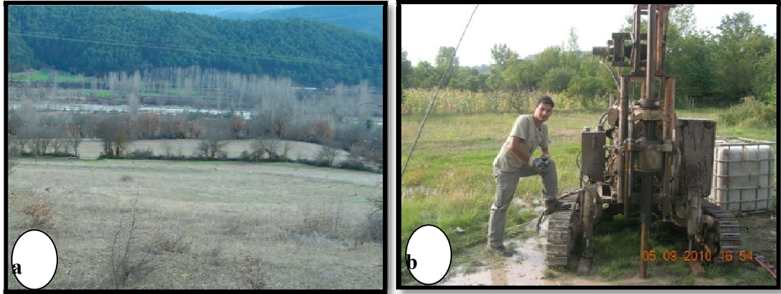
Şekil 3.12. (a) Santral binası alanı (b) ve santral alanında açılan sondajlar (kot: 562 m)
