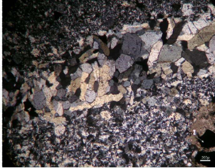
Şekil 3.14. Çayeli masif sülfid merceğinin tabanındaki silisleşmenin kuvars damarı ve matriksteki görünümü (Ç.N. Örnek no: 1740/6 147 m.). (K: Kuvars, Op: Opak mineral).
