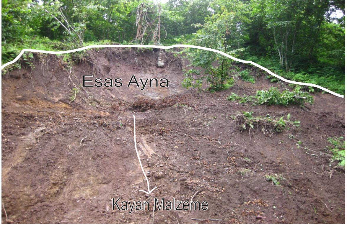
Şekil 24. Heyelanın esas ayna üst sınırı
