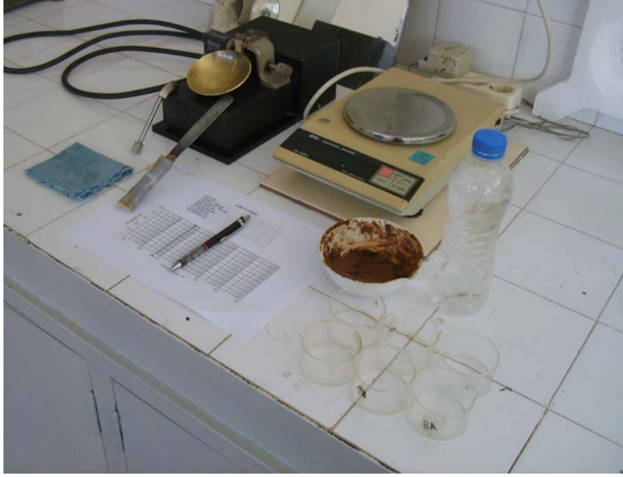
Şekil 9. Casagrande aleti ve deneyde kullanılan malzemeler
