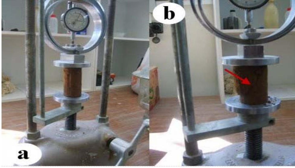
Şekil 17. a) Serbest basınç aleti b) Numunenin kırılma hali
