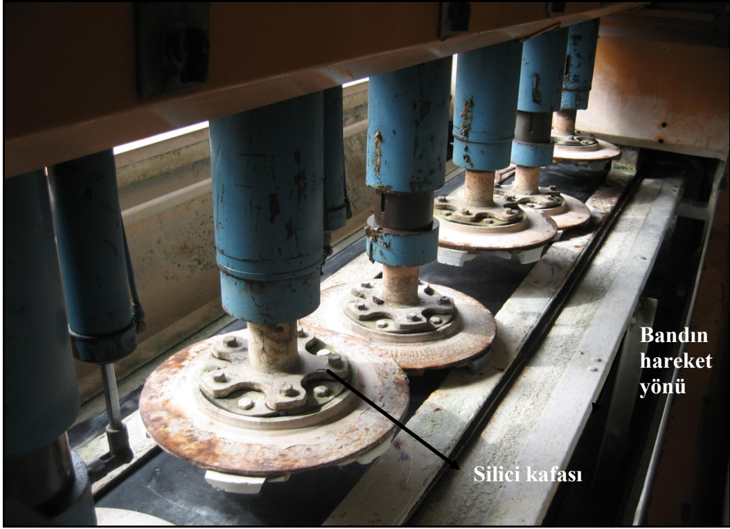
Şekil 3.17. Cila makinesi ve kullanılan silici kafaların görünümü
