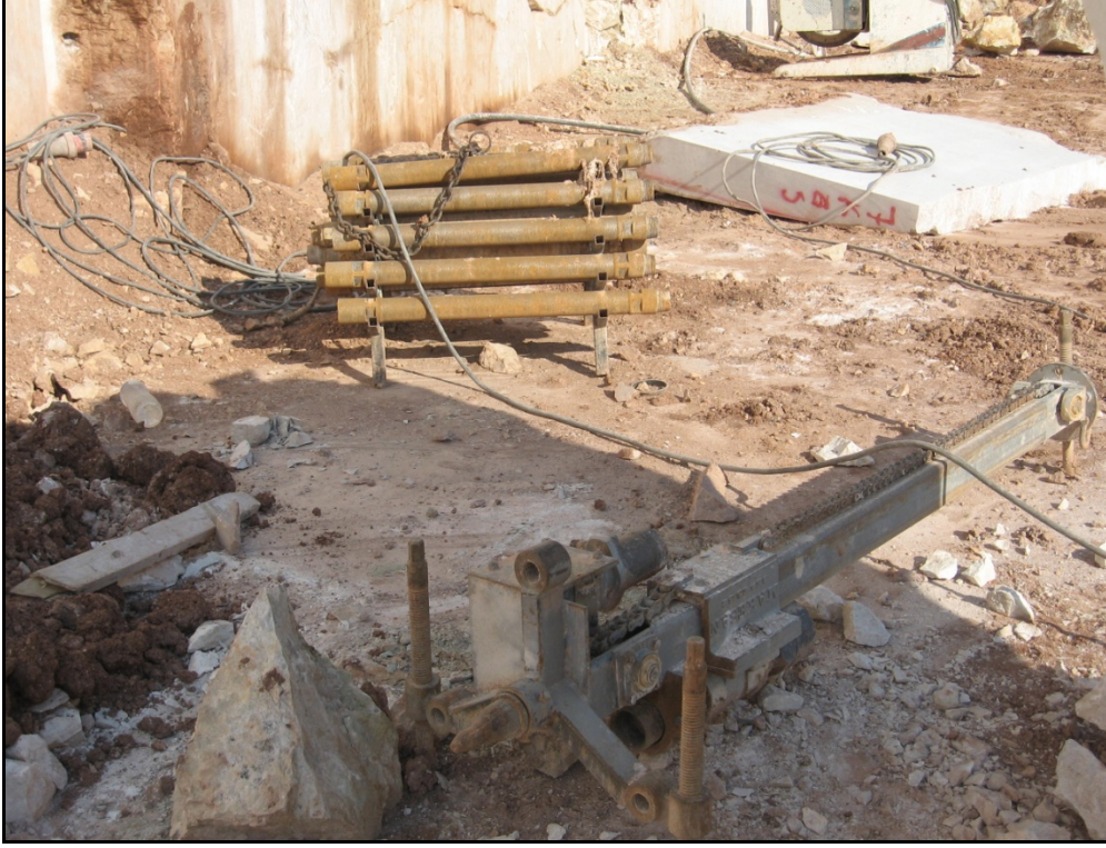
Şekil 3.9. Bloкта delikler açmada kullanılan sondaj alet kısımları
