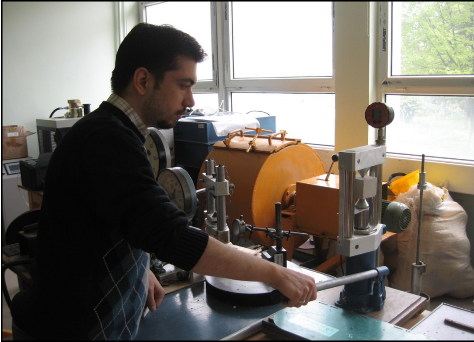
Şekil 2.19. Nokta yük deneyinin yapılışı
