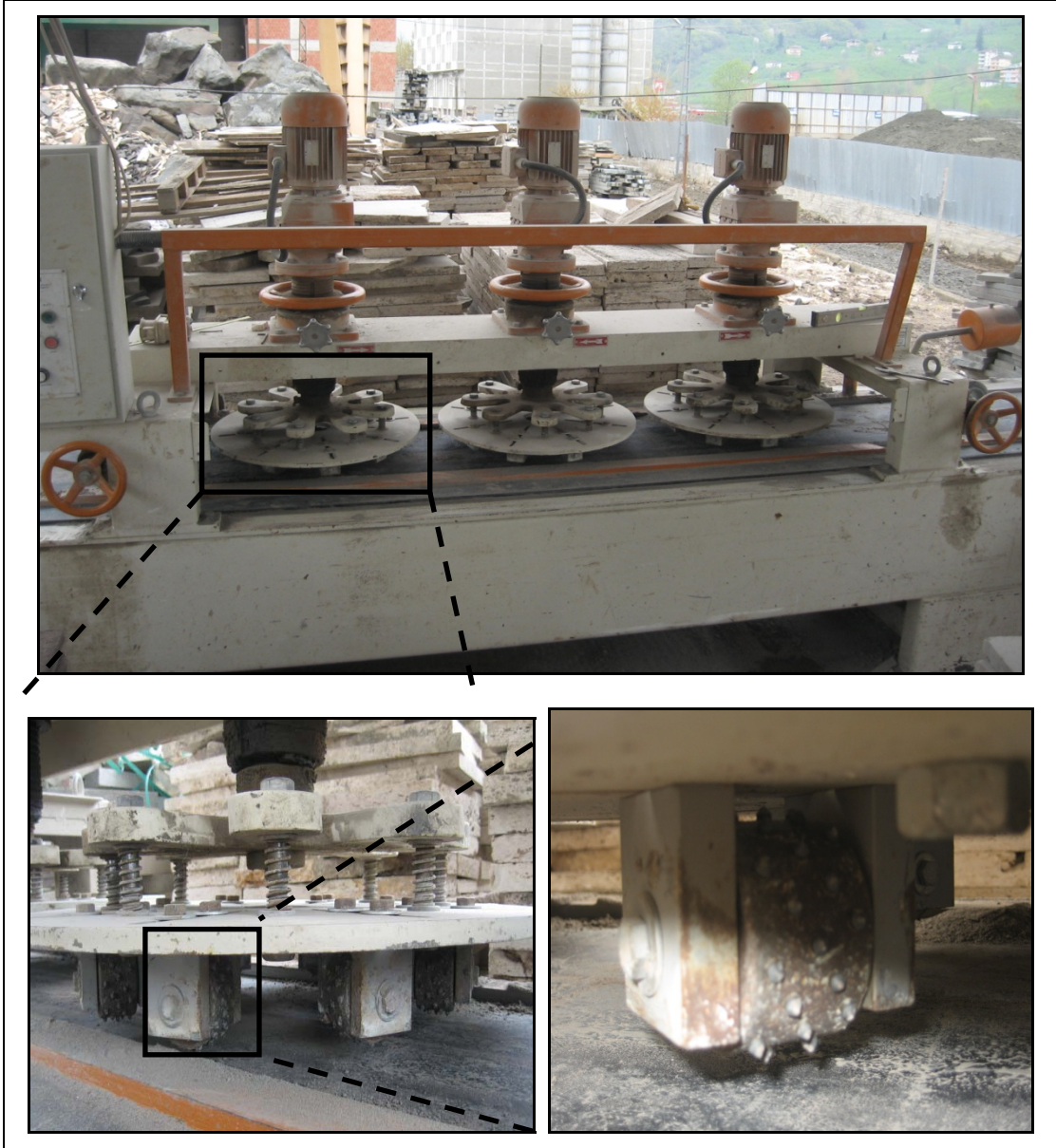
Şekil 3.24. Çekiçleme makinesi ve sert uçların görünümü
