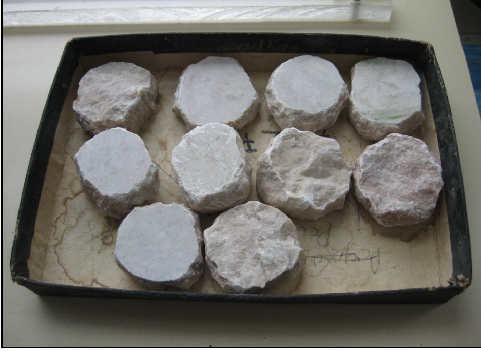
Şekil 2.24. Duraylılık deneyi için hazırlanan örneklerin görünümü
