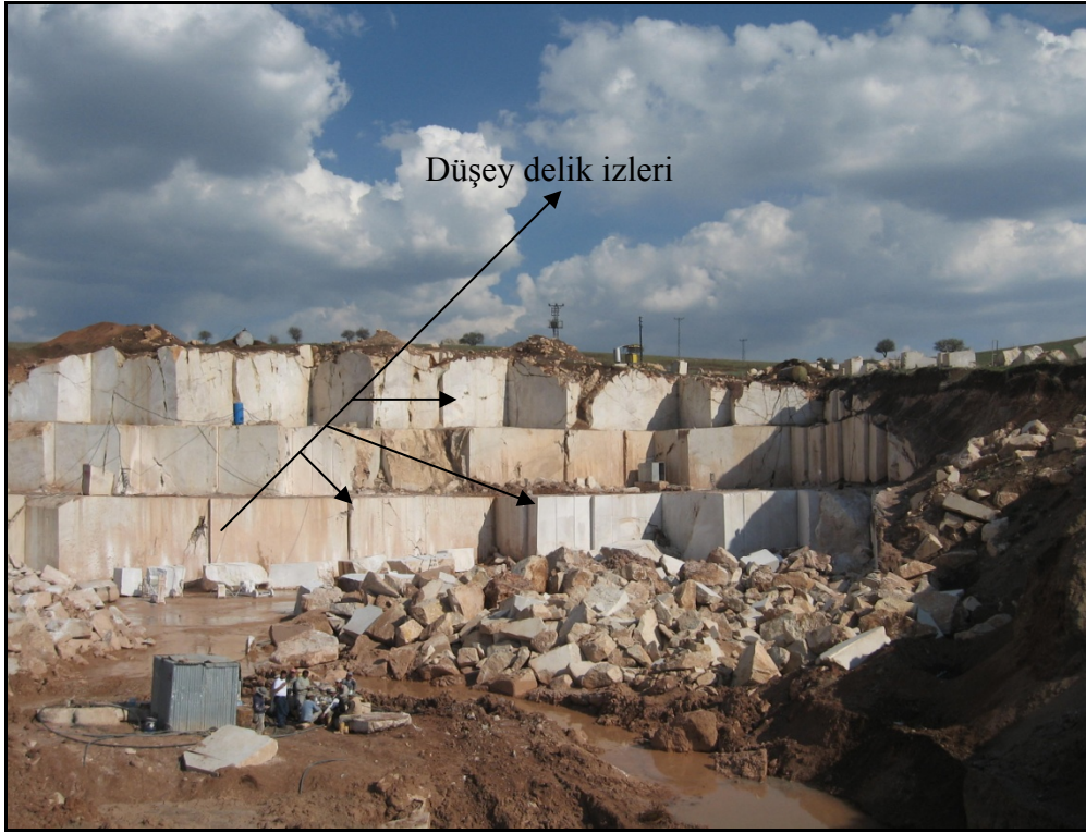
Şekil 3.10. Üretim aşamasında bloktaki düsey delinen delik izleri
