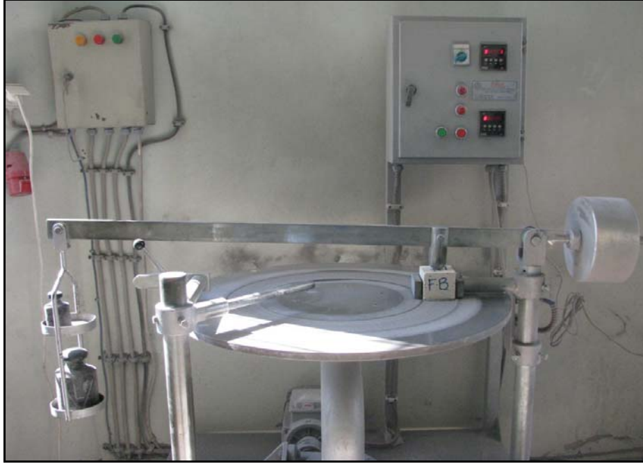
Şekil 2. 14. Sürtünme ile aşınma kaybı deney aleti düzeneği
