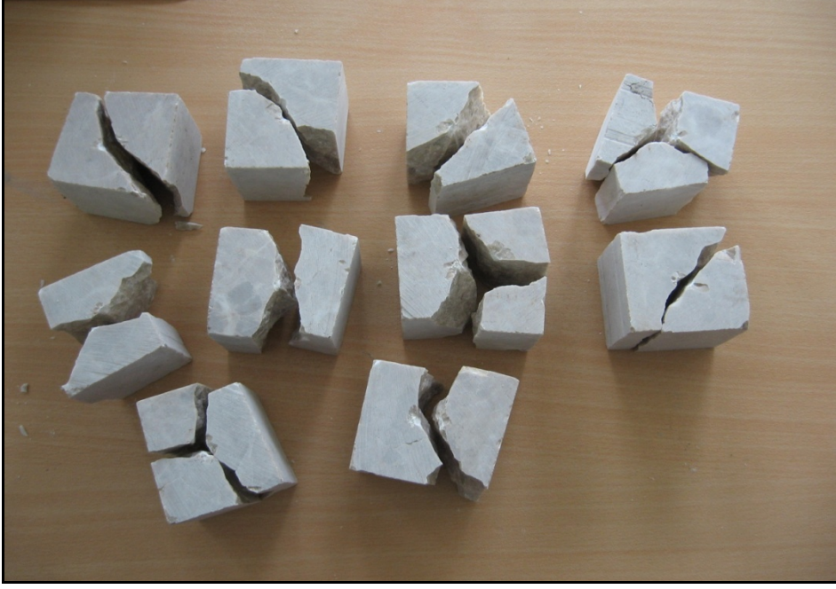
Şekil 2.20. Nokta yük deneyi sonucu kırılmış örneklerin görünümü
