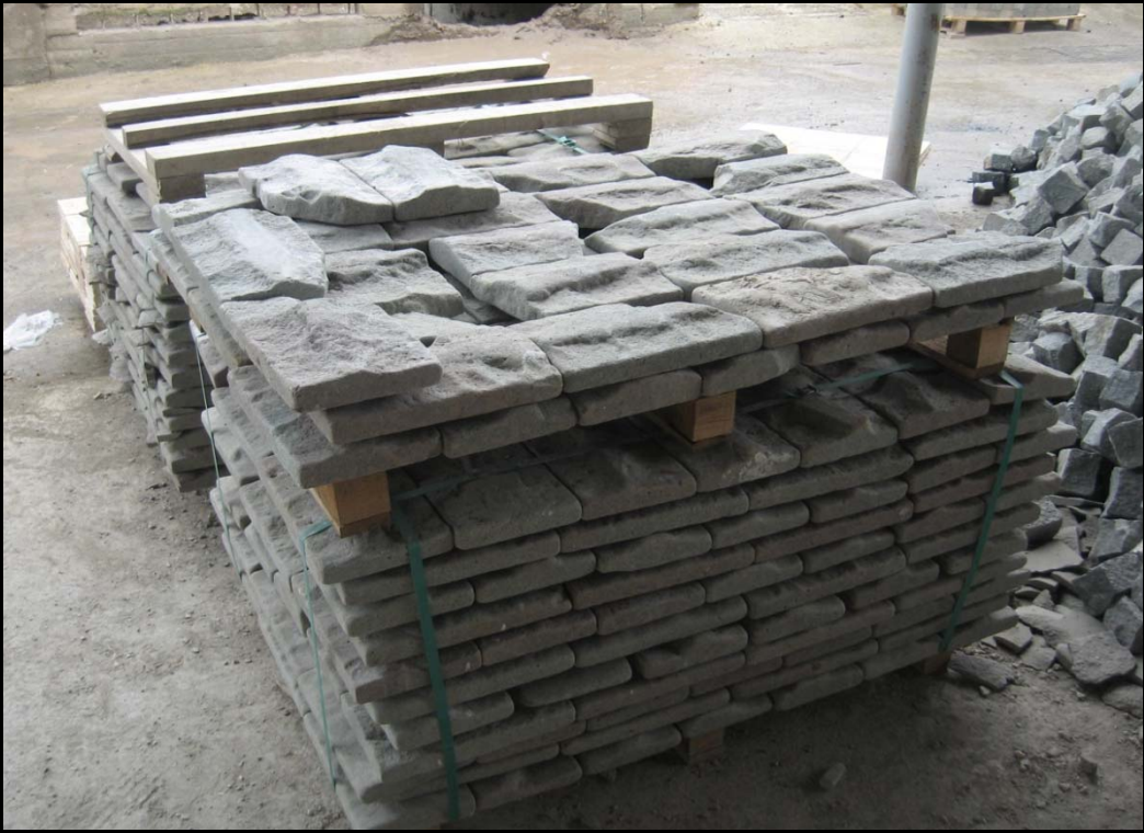
Şekil 3.21. Eskitme uygulanmış taşların görünümü
