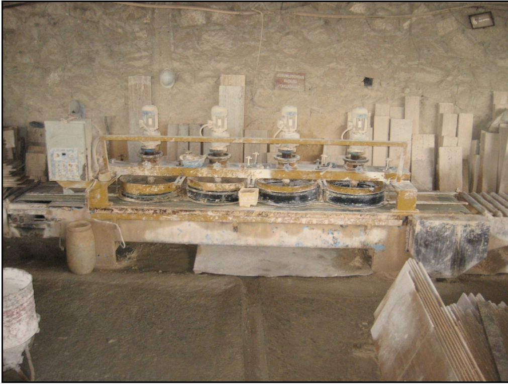
Şekil 3.22. Macunlama makinesinin karşıdan görünümü
