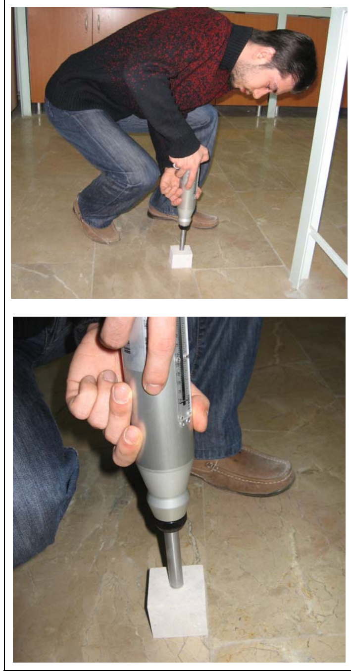
Şekil 2.3. Sertlik derecesi (Schmidt çekici)'nin belirlenmesi
