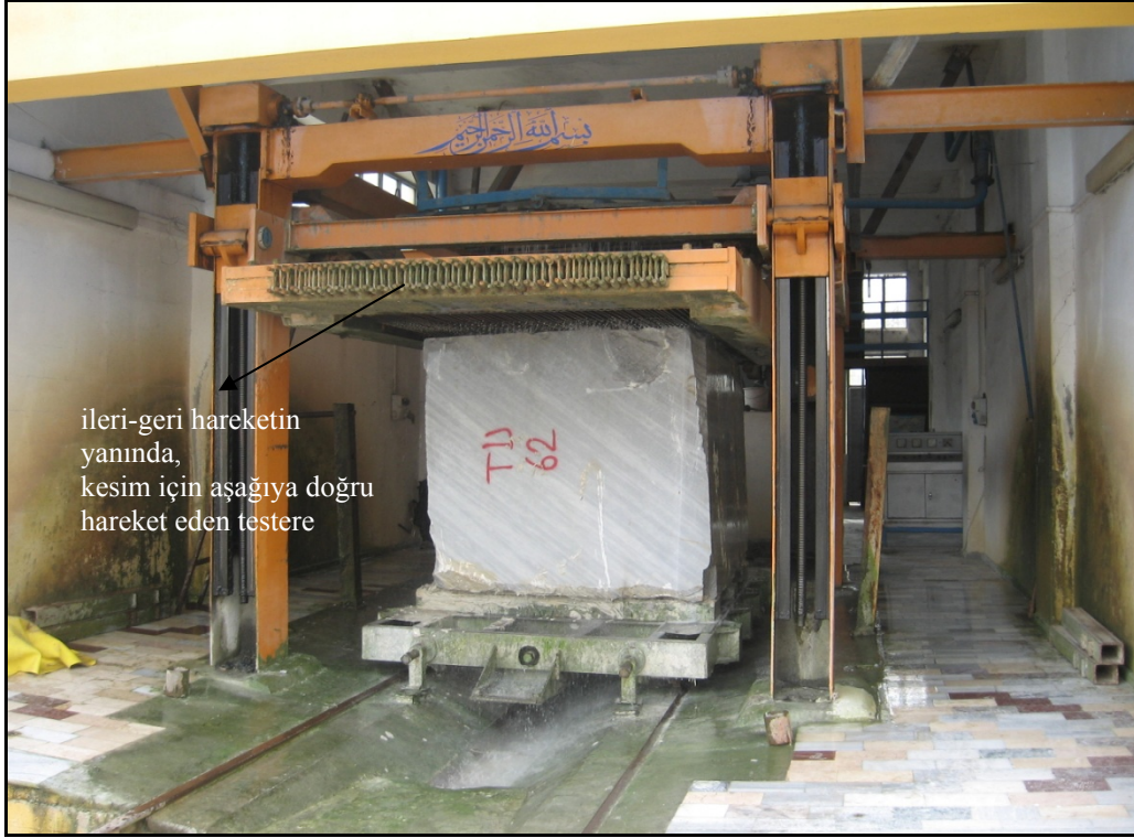
Şekil 3.14. Birinci tip kesim işleminde katrağın önden görünümü
