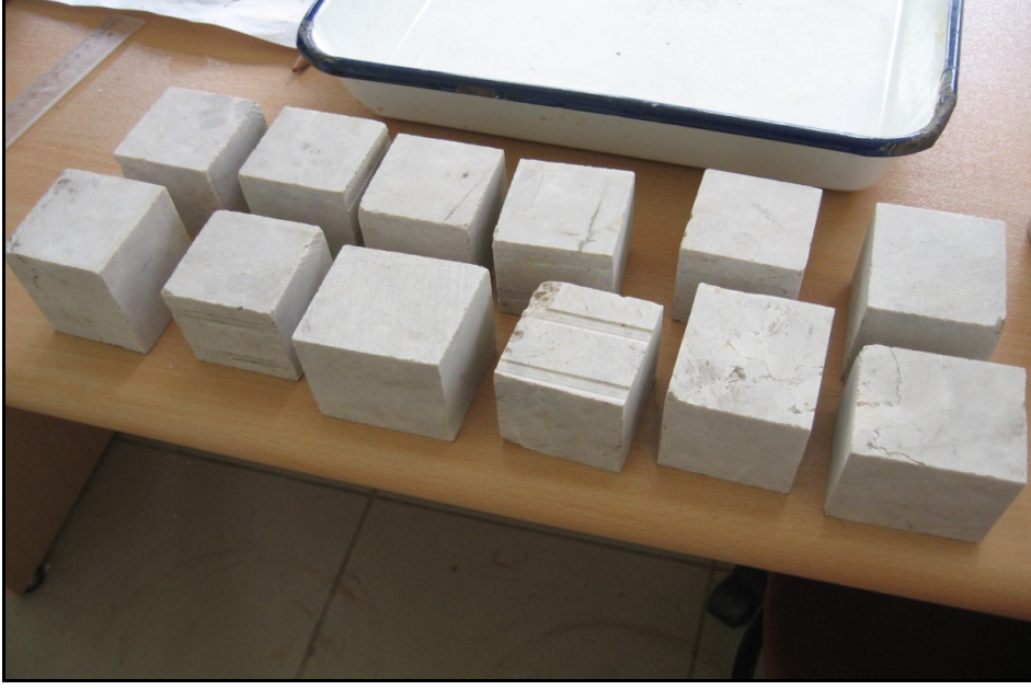
Şekil 2.18. Nokta yük deneyinde kullanılan numunelerin görünümü
