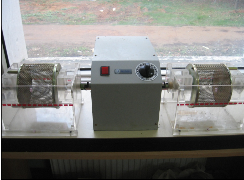
Şekil 2.25. Suda dağılmaya karşı duyarlılık deney aleti düzeneği
