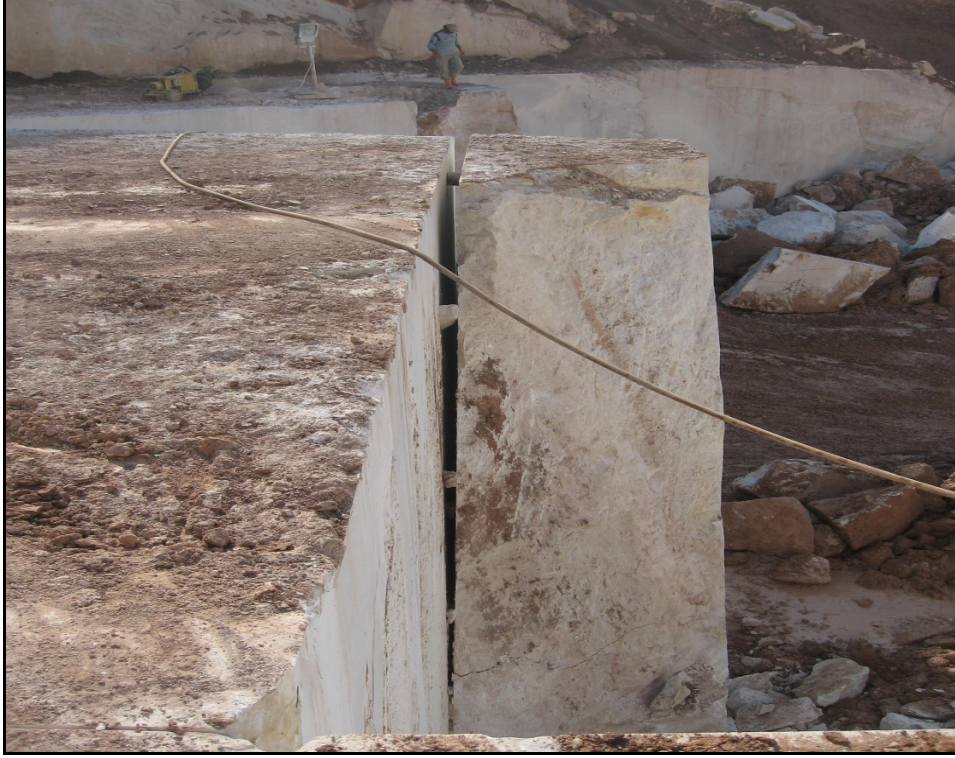
Şekil 3.11. Yan kesim yapıp çıkartılmaya hazır bloğun görünümü
