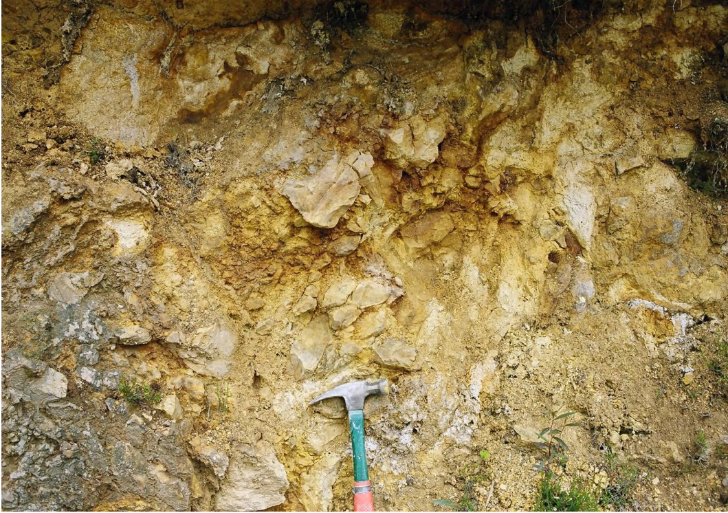
Şekil 10. Eriklik köyü batısında gözlenen sarımsı renkli riyodasitik-dasitik breşi ve bağlayıcıda gelişen killeşme.
