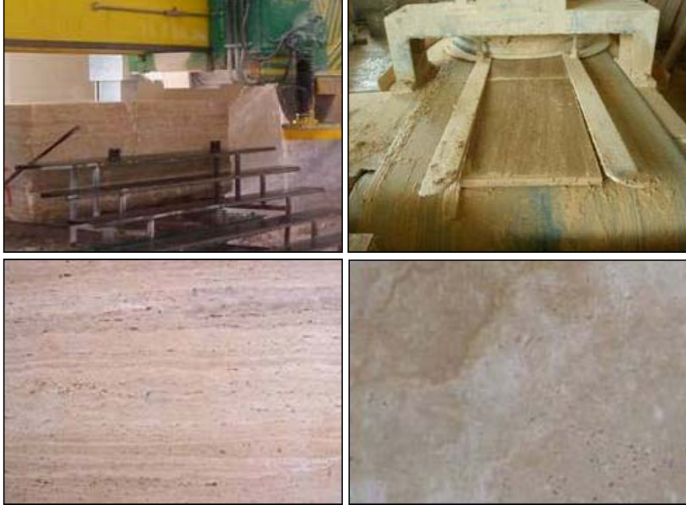
Şekil 3.19. Fabrikada travertenlerin kesim, dolgu ve cila işlemi
