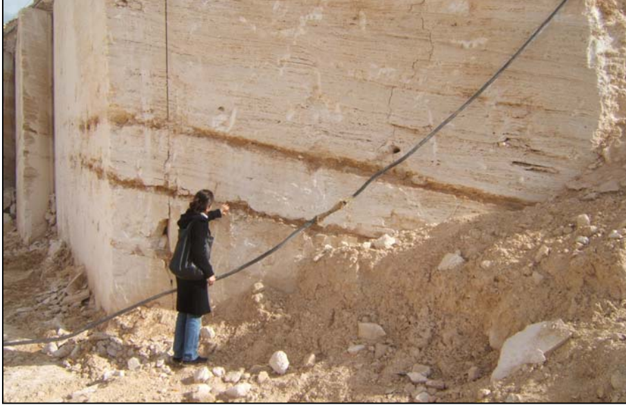
Şekil 3.17. Kalecik traverten ocağının blok kalitesini düşüren ve kalınlıkları yer yer 10 cm'ye varan zayıflık düzlemleri
