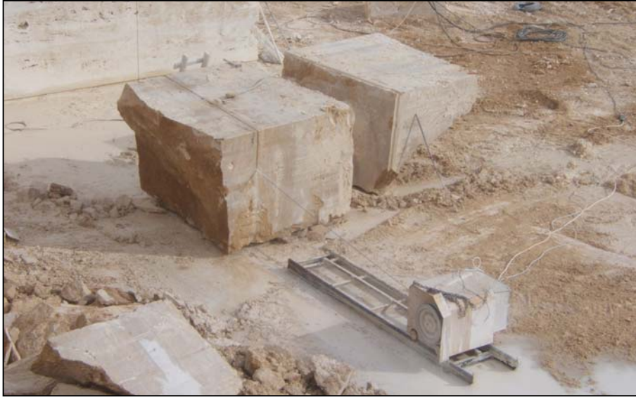
Şekil 3.16. Kalecik traverten ocağında üretilen blokların istenilen boyuta getirilebilmesi için kesilmesi
