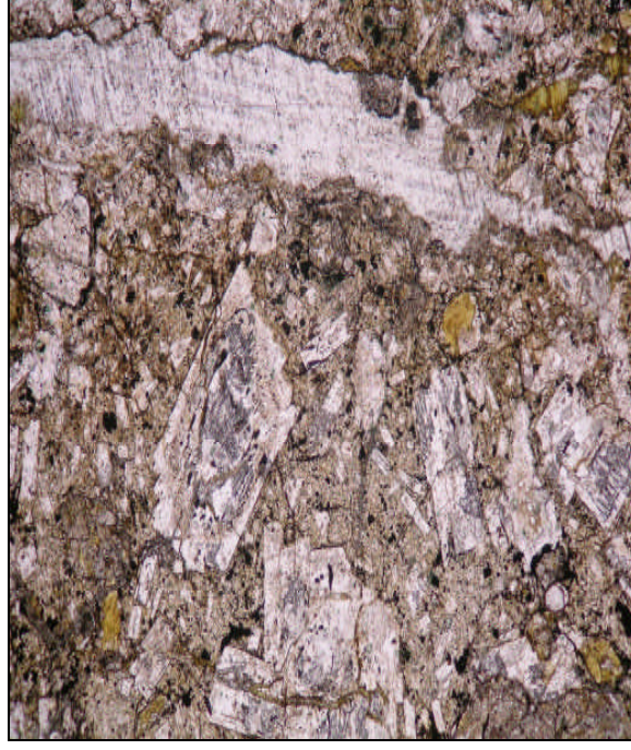
Şekil 8. Gümüşhane granitinin ince kesit görüntüsü (Ç.N).
