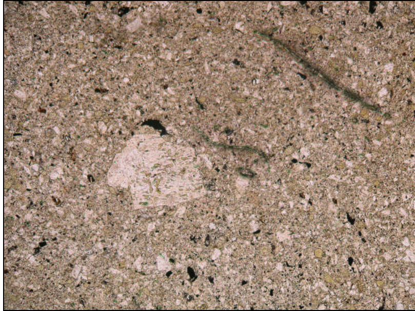
Şekil 14. Kabaköy Formasyonundan alınan volkanik tüfün ince kesitteki görünüşü
