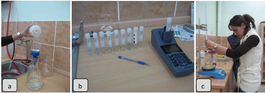
Şekil 2.3. a) Süzme işlemi yapılan vakum filtrasyon sistemi, b) WTW photoflex Turb marka cihaz, c) Titrasyon yöntemiyle HCO 3 - ve CO 3 -2 analizleri yapımı
