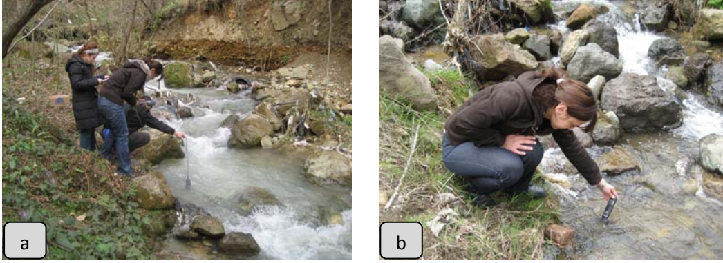
Şekil 2.2. a) Horiba U-10 marka cihazla yapılan yerinde ölçüm, b) Hanna marka çoklu parametre ölçer ile yapılan yerinde ölçüm
